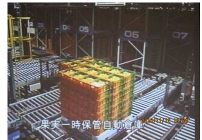
暫時保管之自動倉庫
