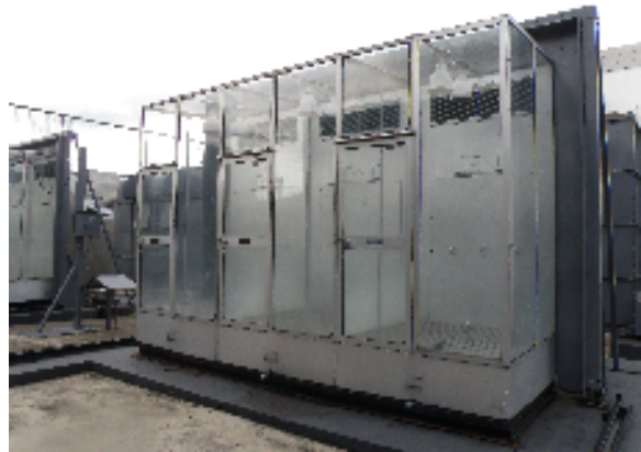
圖十六、水稻耐熱性試驗生長箱
