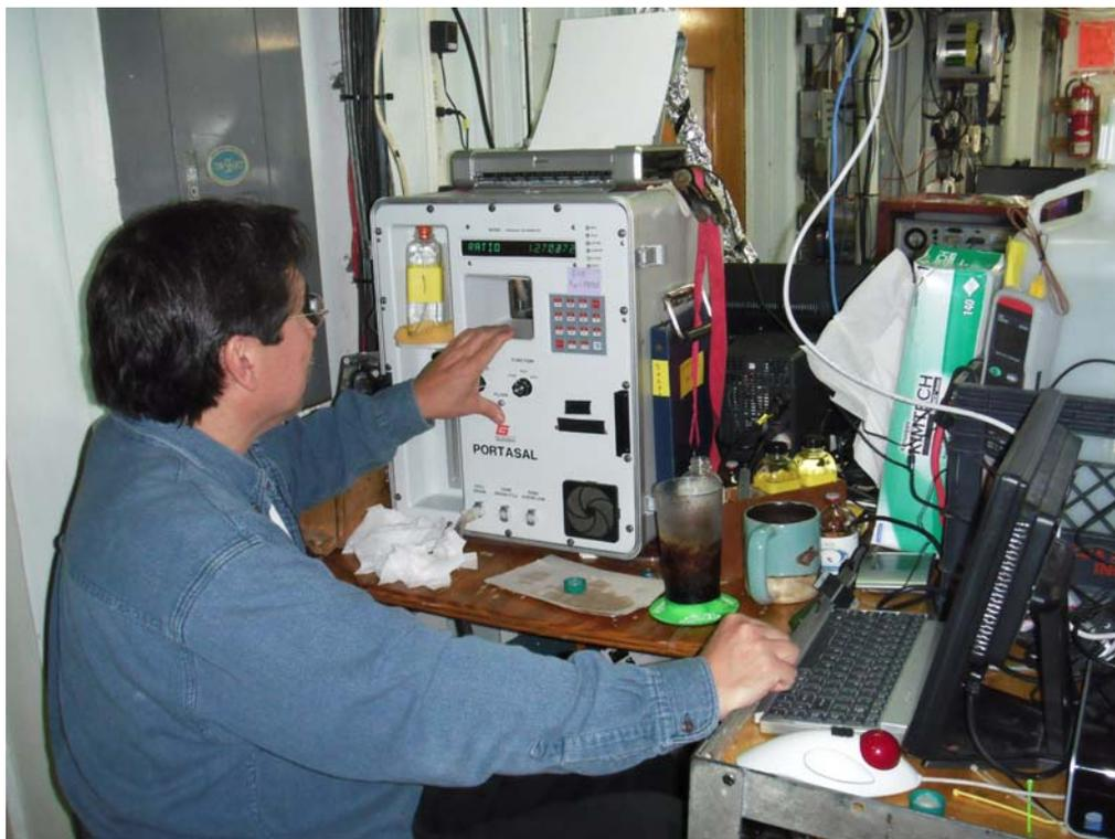
圖 29、以鹽度計測定各水層水樣之鹽度，樣本重複測定五次。
