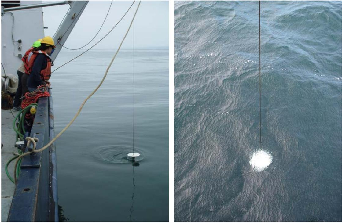
圖 33、投放透明度板(sacchi disk)，目測水層透明度。
