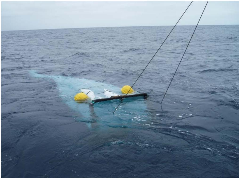
圖 40.3、Oozeki 網具入水，下放至預定深度後以斜拖方式上揚。
