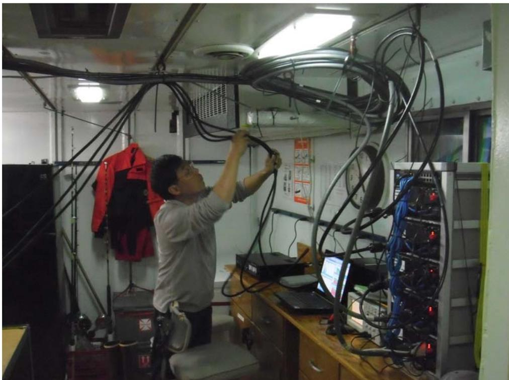
圖 11.5、組裝五種頻率(18, 38, 70, 120, 200 kHz)之聲探管路。
