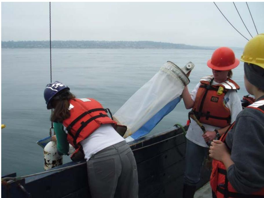
圖 35.3、拆卸網具，準備結附 Manta 網具。
