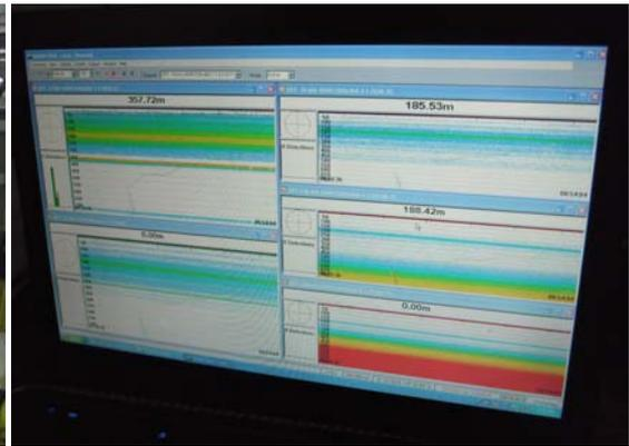
圖 39.1、五種頻率(18, 38, 70, 120, 200 kHz)之聲探。
