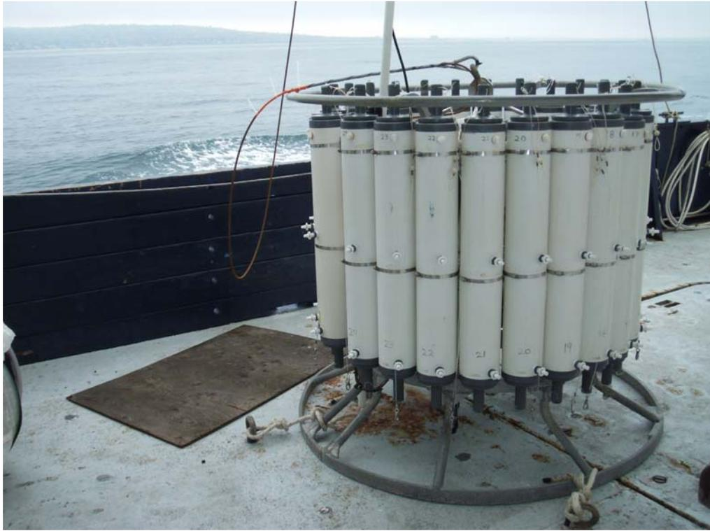
圖 14、可採集 24 個水樣之輪盤採水系統。
