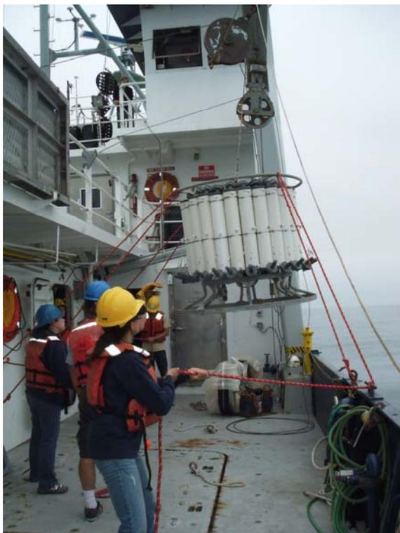
圖 19.2、另外以三條纜繩控制採水器，避免搖晃過大發生碰撞。
