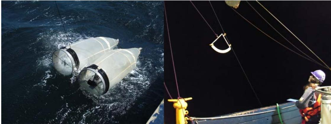
圖 37.2、將 Bongo 投放至 210 米以斜拖方式上揚，並記錄角度變化。
