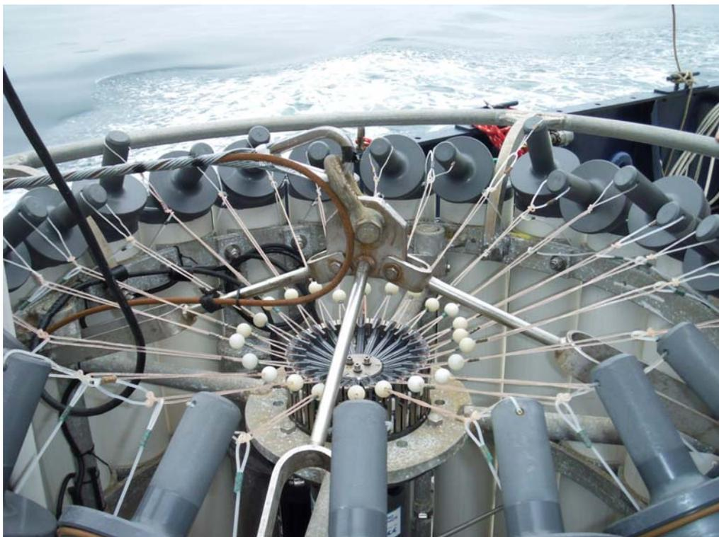
圖 15、磁控式採水瓶擊發系統。
