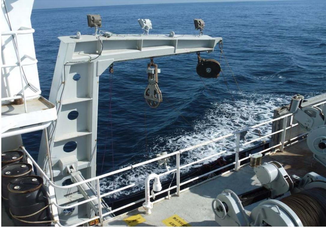
圖 18.1、投放採水器與網具之 J 型吊臂(J-frame)。
