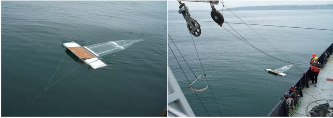
圖 36.1、Manta 網具以水平方式拖曳 15 分鐘。
