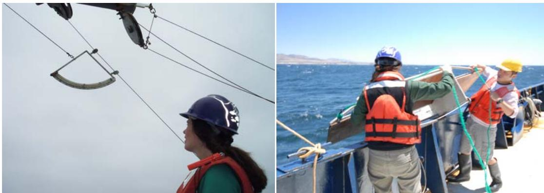
圖 36.3、鋼纜結附量角器，記錄投放過程中鋼纜角度之變化。
