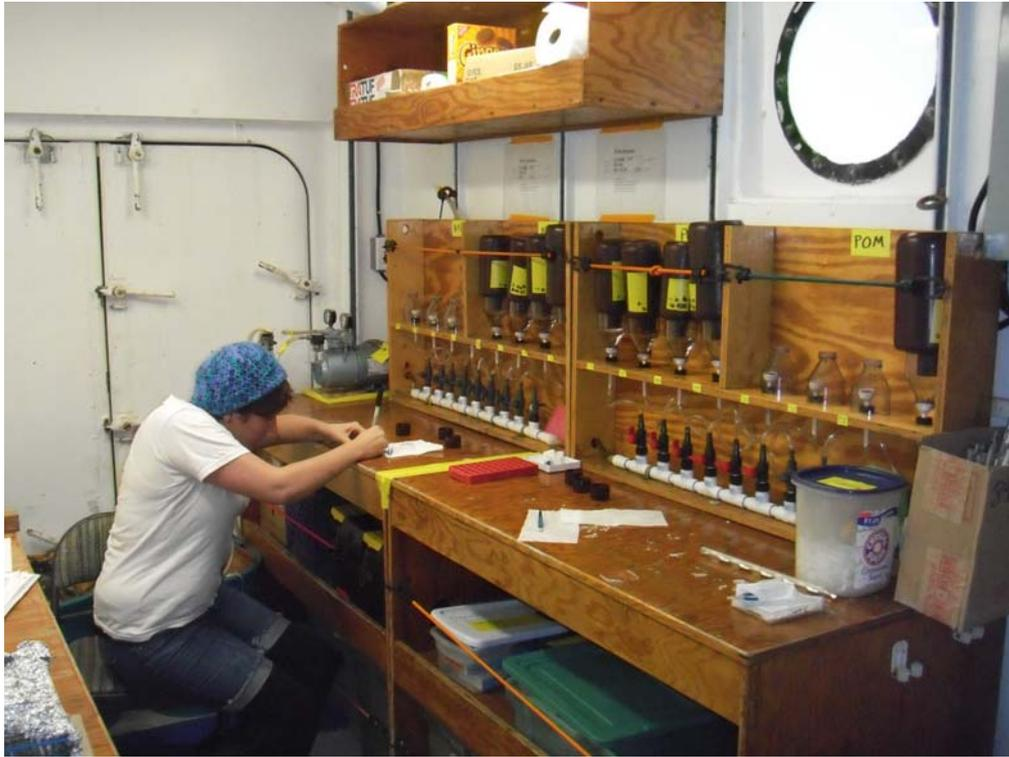
圖 31、以濾紙過濾水樣，攜回實驗室進行 HPLC、POM、DOC、DON 等實驗。
