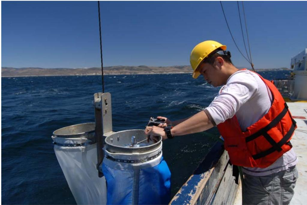
圖 35.2、以海水噴霧器徹底沖洗網具避免殘留。
