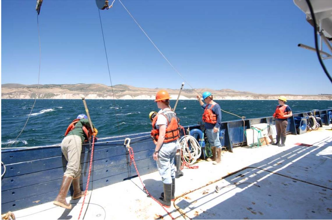
圖 24.1、採水器準備出水，研究人員將控制用纜繩勾掛至採水器。
