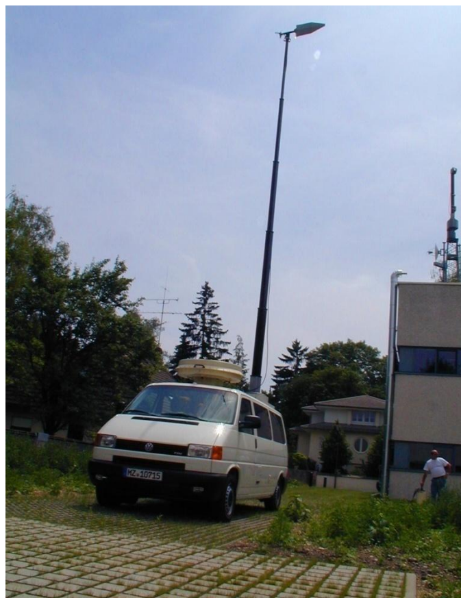
圖 2(b) 行動監測車（頻段：20-30 MHz）
