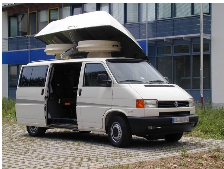
圖 2(b) 行動監測車（頻段：20-30 MHz）
