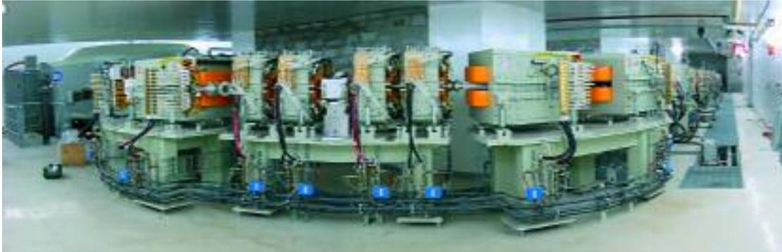
質子射束的行進路徑，包括轉向磁鐵、聚焦磁鐵、補充能量元件、抽真空幫浦等。
