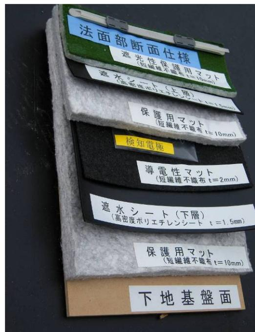
圖 38. 不透水布鋪設標準模型圖
