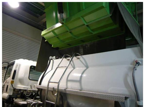
圖 19. 分選後之廢棄物直接裝置至卡車上並載運至處置廠掩埋
