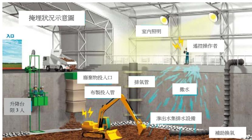
圖 9. 倉儲式最終處置場內部掩埋狀況示意圖
