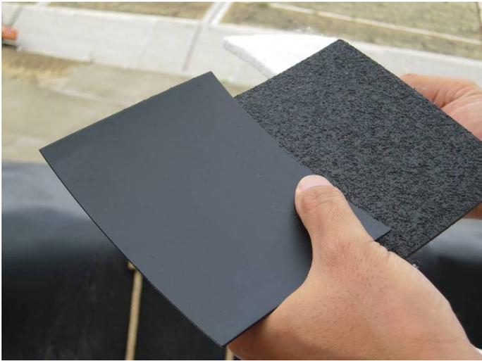
圖 41. 邊坡之不透水布為避免因重力滑落，故設計摩擦係數較大之不透水布
