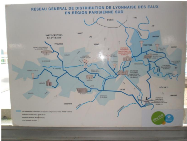
圖 4 Morsang 淨水廠必要時可經由管網閘栓調節支援巴黎市用水
