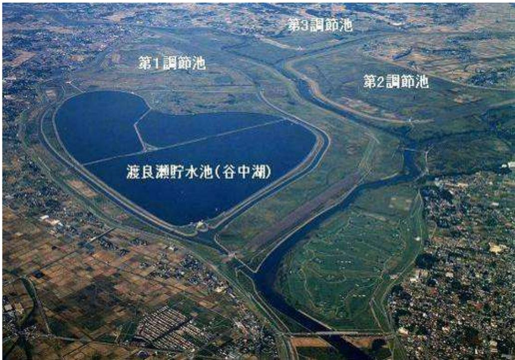
圖 3-16 渡良瀬滯洪池的平面配置
