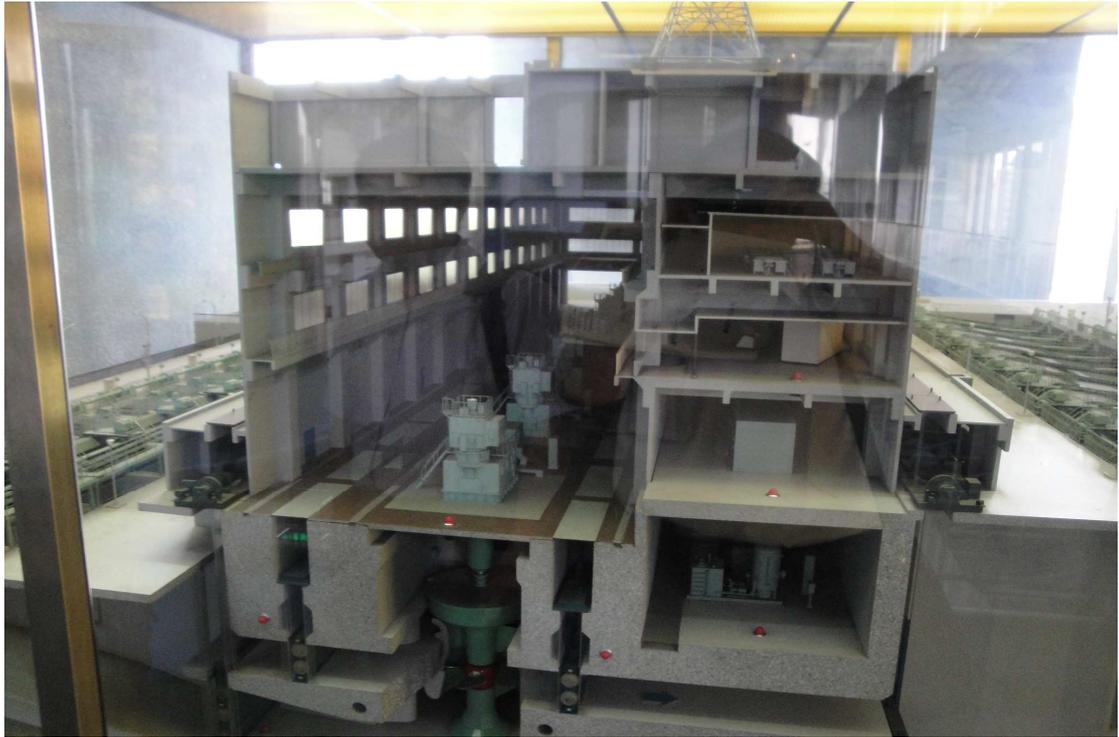
圖 3-39 毛馬抽水站機房內所建置抽水站模型剖面，抽水機共 6 部，每部 55cms
