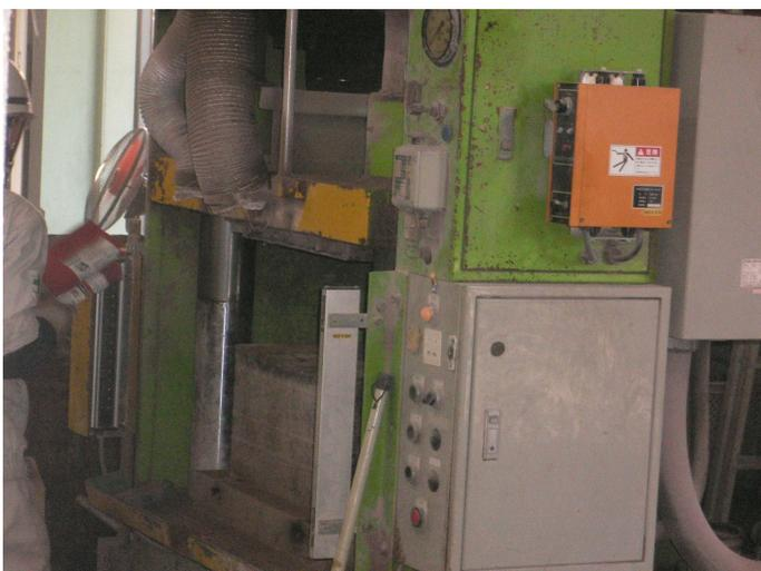
圖 7 回收鋼瓶壓毀作業
