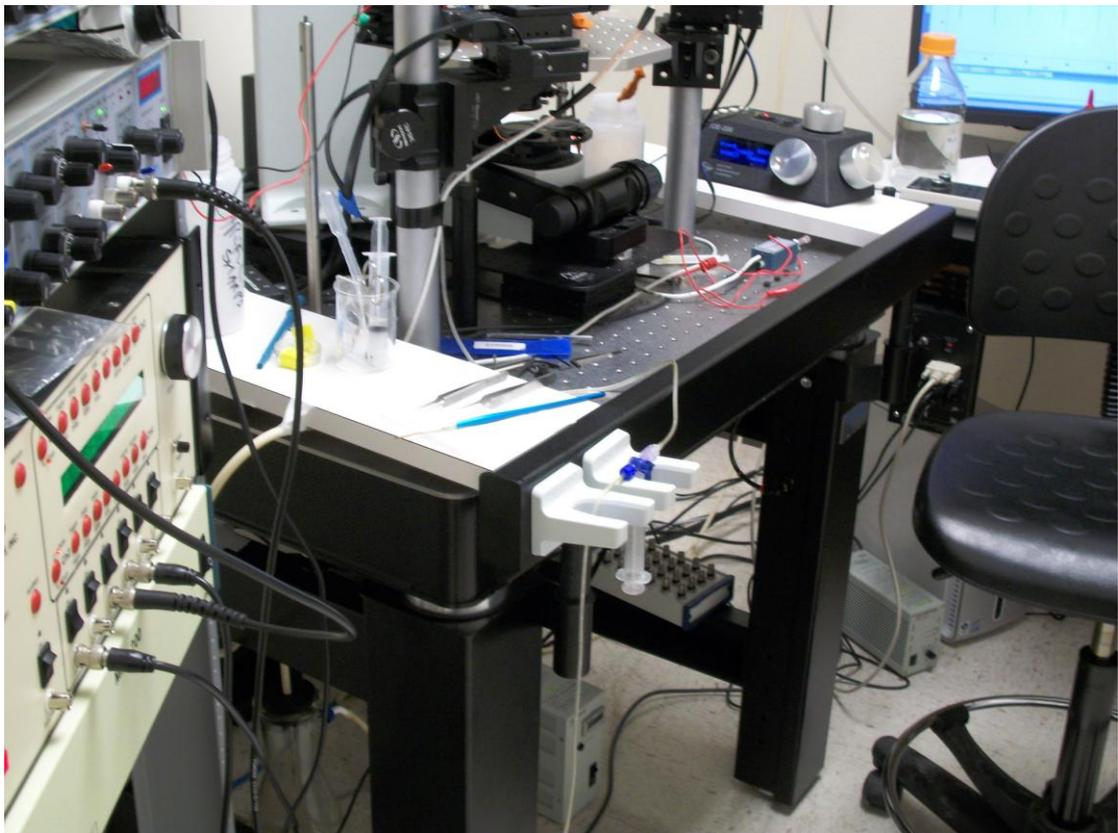
盛放光電顯微鏡的實驗桌利用磁浮原理避免震動干擾訊號偵測
