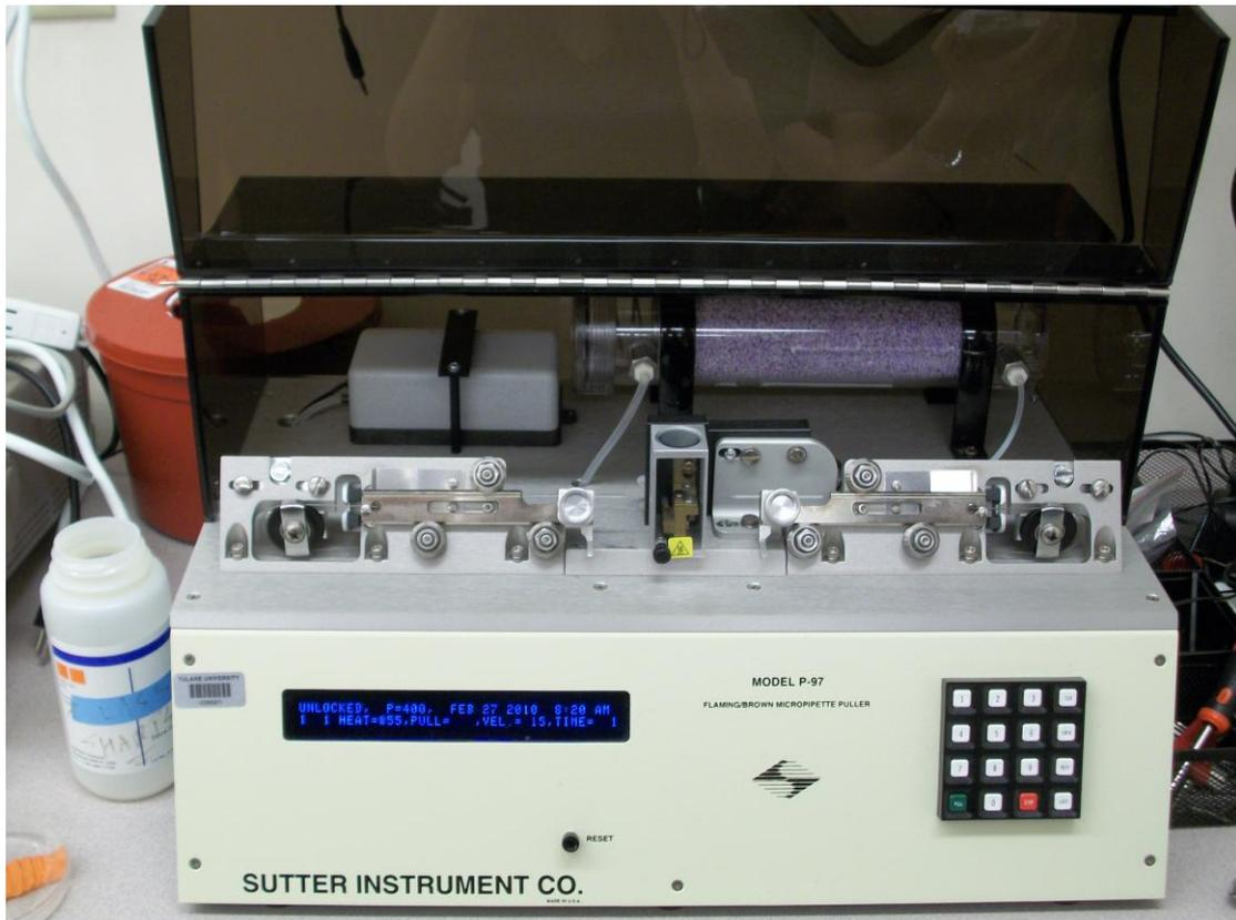
光電顯微鏡的玻璃探針製備機
