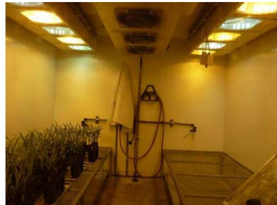
圖38. AAFC之基因轉殖植物中心走入式生長箱內部配置
