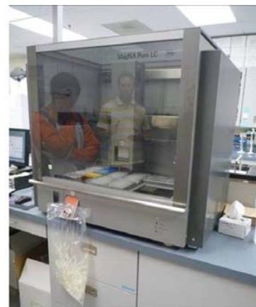
圖57.以自動萃取系統自動萃取DNA，黃衫者為負責解說的Steven先生
