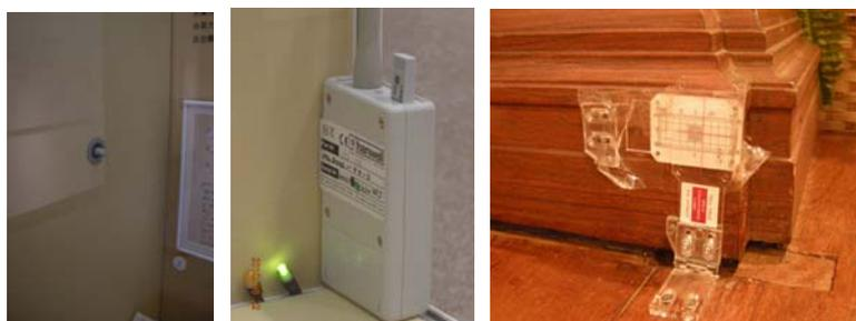
圖 4 香港孫中山紀念館陳列櫃本身設的溫溼度感測器（左圖），並連結 LED 燈顯示櫃內環境符合標準與否，重點展櫃還配置 Hanwell 溫溼度無線感測器（圖中）此歷史建築，設置了柱腳傾斜監測尺，以偵測建築物的結構性（右圖）。
