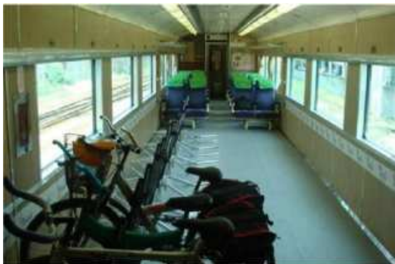
圖 16 改造完成附加自行車車架之莒光號車廂
