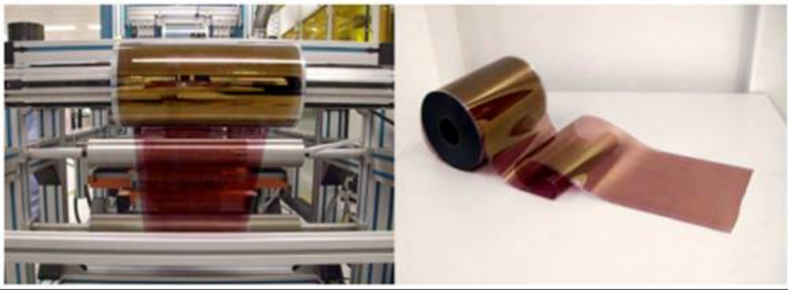
圖 51 使用 Roll to roll 製程於 PET 上塗佈 PEDOT:PSS 與主動層
