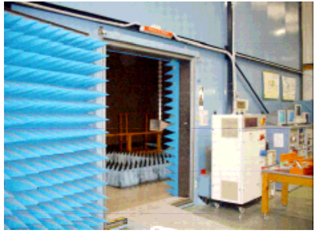
圖 18、UL 義大利實驗室的溫濕交變（左）與電磁波（右）相關的測試系統
