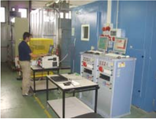
圖 18、UL 義大利實驗室的溫濕交變（左）與電磁波（右）相關的測試系統
