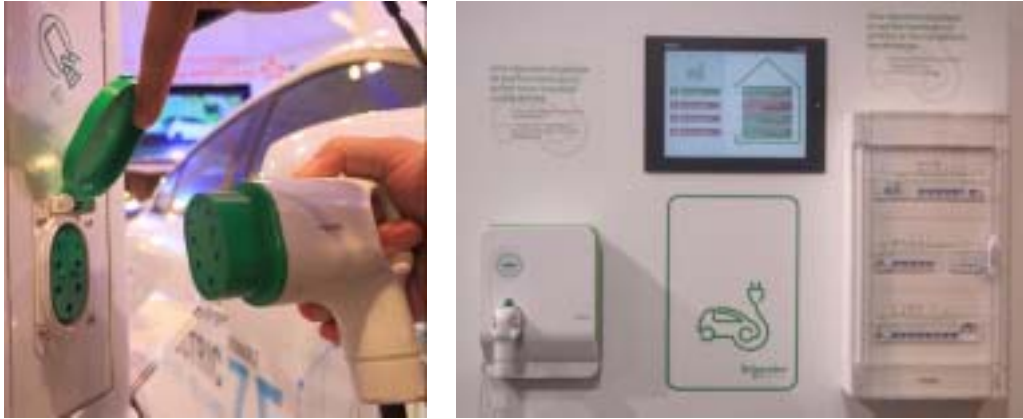
圖 36、Schneider 公司提供之慢充與家庭能源管理系統
