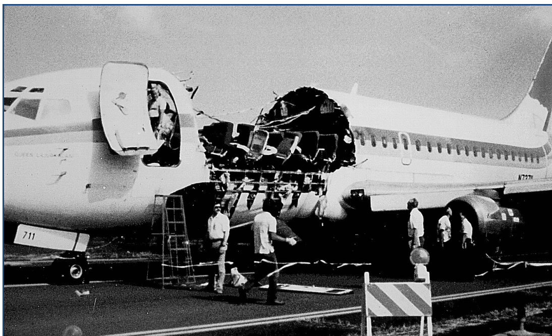
圖 3-5 阿囉哈航空（Aloha Airlines）發生爆炸性洩壓及飛機結構失效之案件
