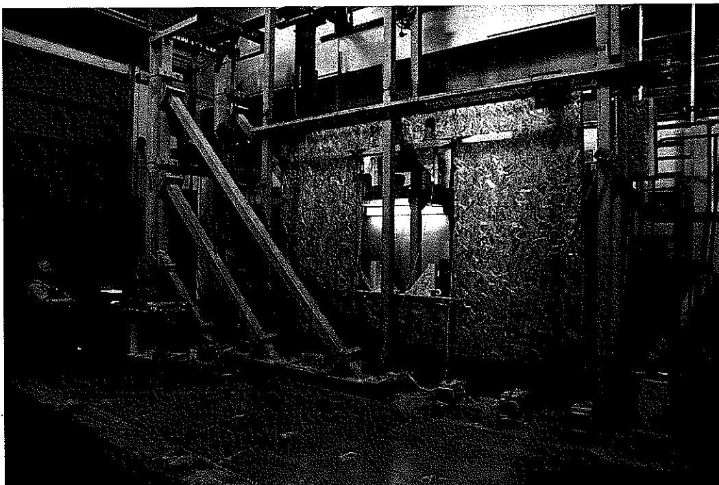
APA 試驗室針對 OSB 結構所進行之抗震試驗
