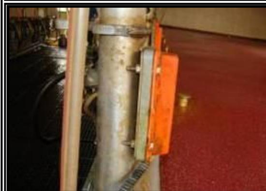
圖 27. 牛號及資料傳輸感應器
