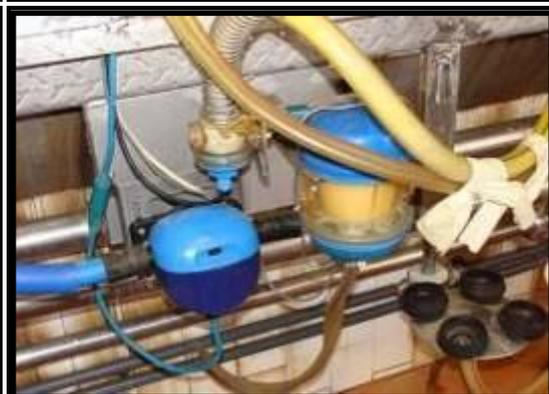
圖 28. 自動式乳成分檢測器
