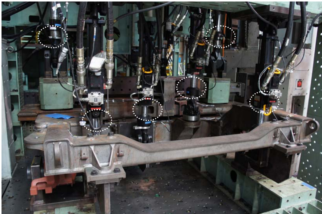
圖 3-4 垂直、煞車、齒輪箱及馬達致動器配置
