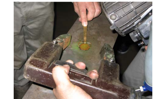
圖 3-20 測試前以美規瑕疵片測試說明
