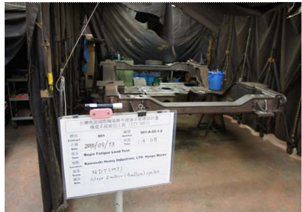
圖 3-16 磁粉探傷作業暗房
