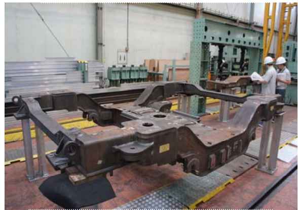
圖 3-10 負荷測試完成後之檢視
