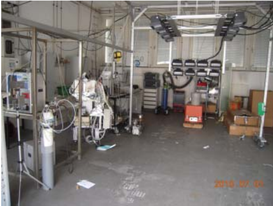
圖 9、汽車內裝材料逸散測試裝置
