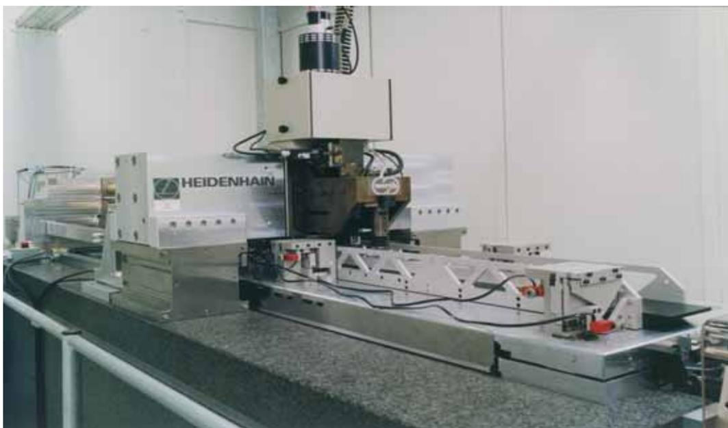
奈米比測儀系統圖(PTB 提供照片)
