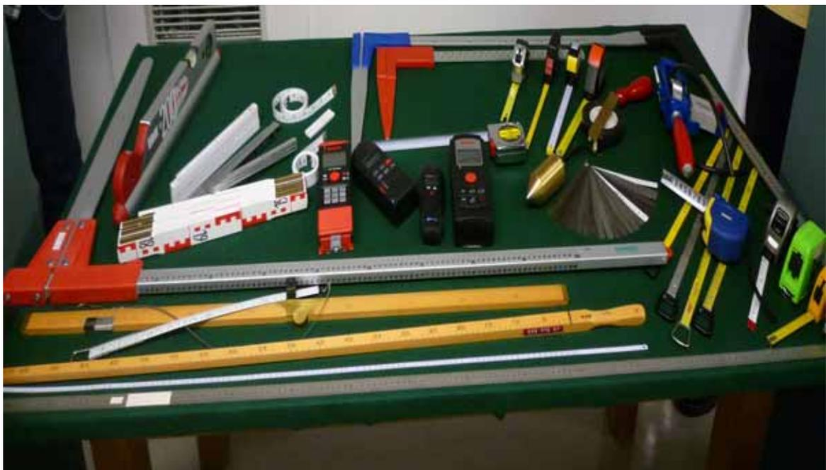
各式樣之量尺(如捲尺、游標卡尺、隙尺、厚薄尺及手持雷射測距儀等)
