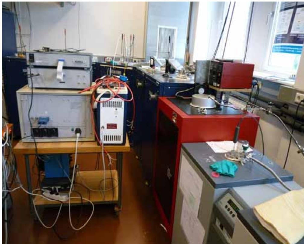
溫度感測器校正實驗室(包含熱敏電阻、熱電偶等之校正)
