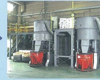
ミックスマラーにて配合した原料を均等に練り合わせた後、ブリケットマシンで加工が施されます。
