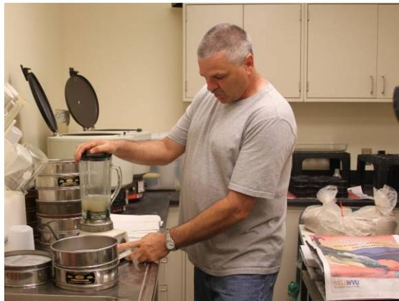
圖 11.高轉速果汁機使孢子與根系快速分離。
