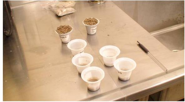
圖 10.將根系與土定量至 50mL 塑膠杯中。
