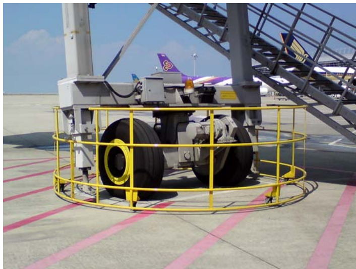
圖 五 名古屋機場確保機坪工作人員安全的網架
