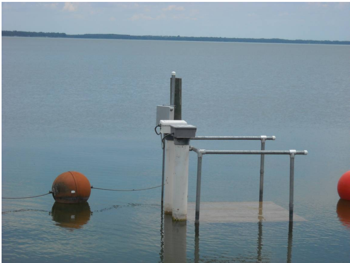
圖 4-14 聖約翰河流域防洪閘門自動控制站上游水位計
