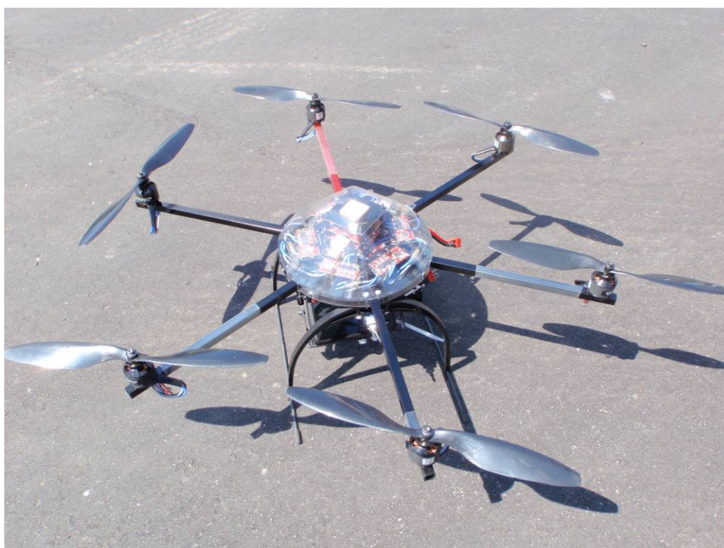
圖 4-17 自製簡易空照飛行器
