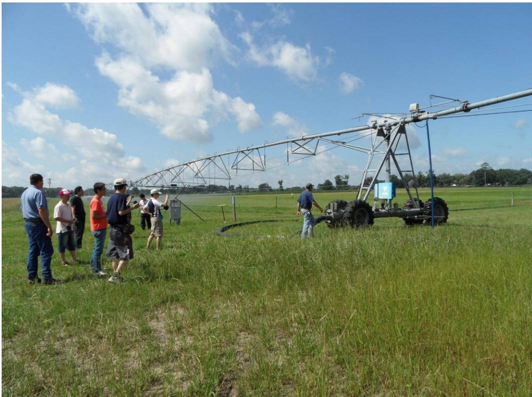
圖 3-8 噴灌器具—Liner Pivot
