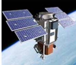
QuickBird 捷鳥衛星為美國 DigitalGlobe 公司所擁有之商用高解析度光學衛星。其於 2001 年 10 月 18 日於美國 Vandenberg 空軍基地順利發射升空；於同年 12 月份開始接收衛星影像。QuickBird 捷鳥衛星係從 450 公里外的太空拍攝地球表面上之地物、地貌等空間資訊，其影像解析度高達 61 公分，為全球首顆提供 1 米以下解析度之商用光學衛星。且 QuickBird 捷鳥衛星為太陽同步衛星，平均 4 至 6 天即可拍攝同一地點的影像。
