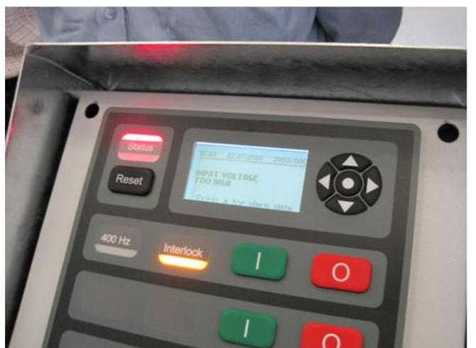
圖 16 過電壓跳脫保護功能測試
