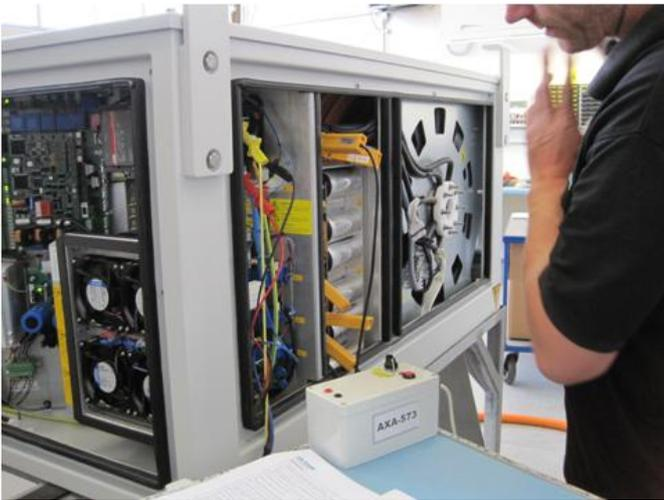
圖 23 模擬中性接地保護故障
