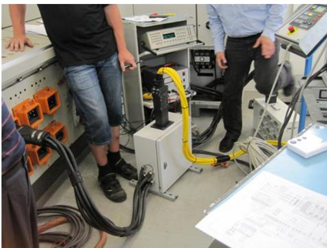
圖 25 AXA 串接兩組負載機進行 250%超載測試
