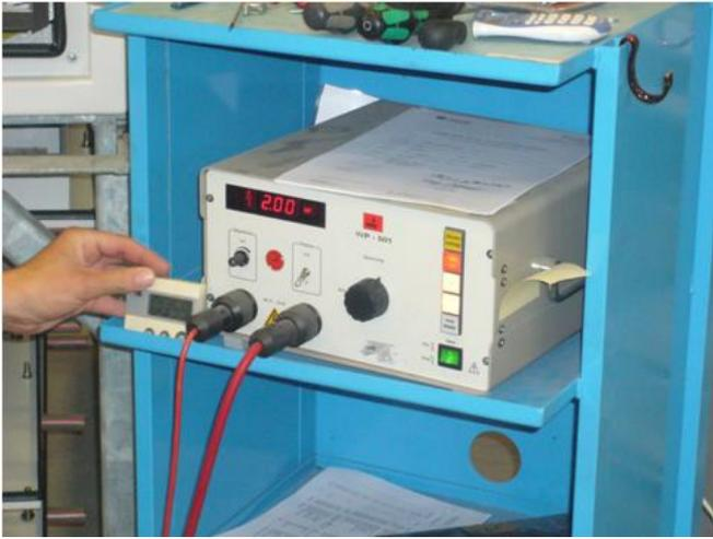
圖 11 高電壓測試器，儀器編號: AXA 477 (WP-501)
