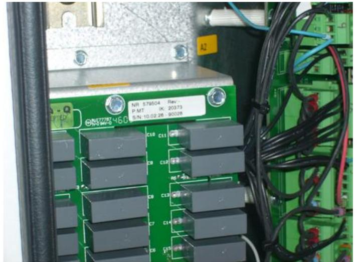
圖 10 核對電路板是否已執行品管測試
