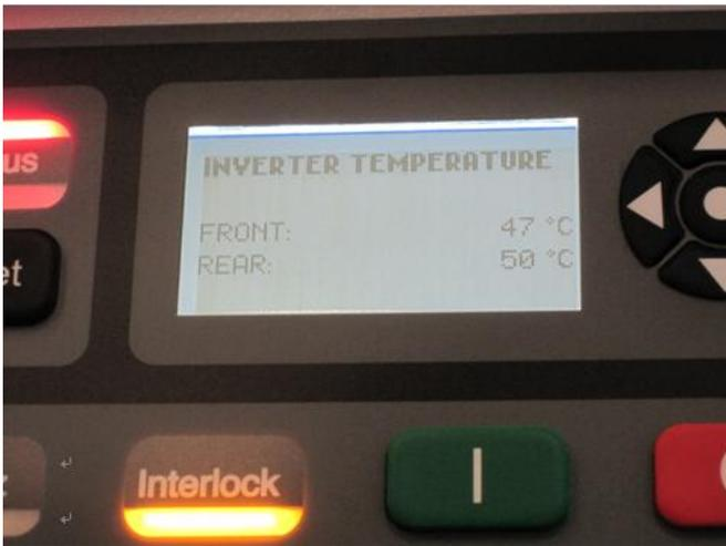
圖 27 溫昇測試後機體內部溫度
