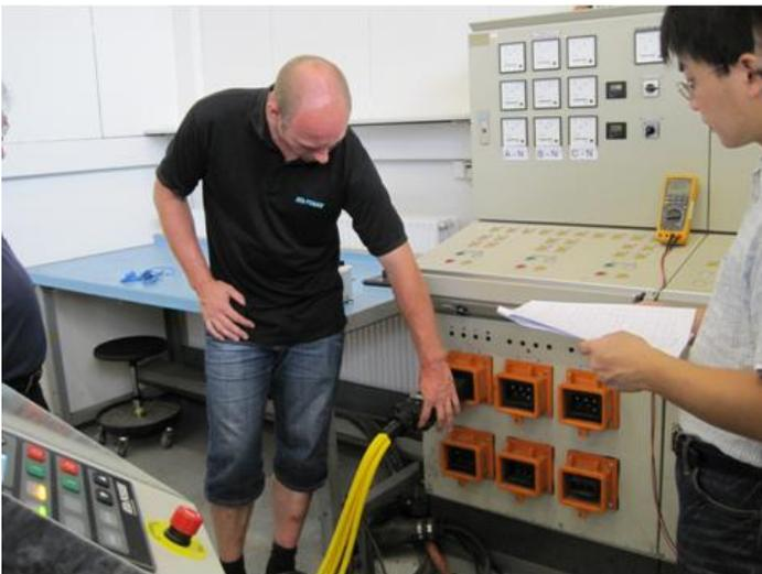
圖 17 利用飛機端插頭壓置開關控制捲線器
