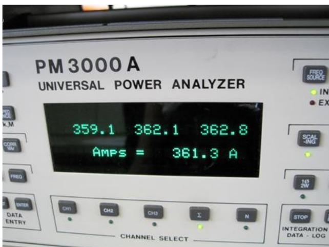
圖 21 設定超負載 150%負載電流 361Amps
