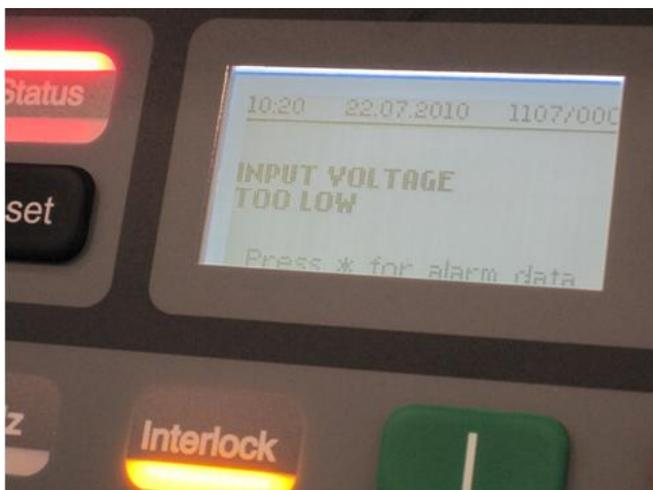
圖 15 低電壓跳脫保護功能測試
