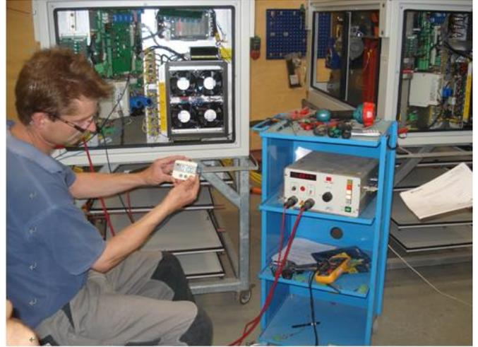
圖 12 設定高電壓測試儀於 2KV，並設定測試時間為 1 分鐘
