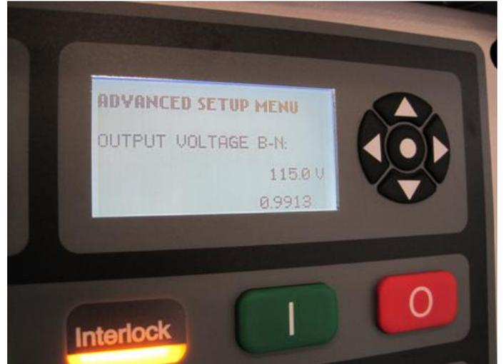
圖 20 確認輸出端電壓為 115V +/- 0.5%
