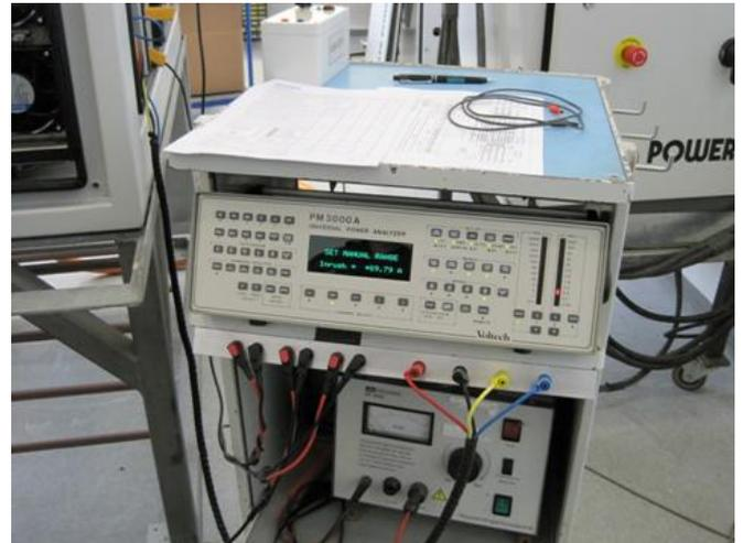
圖 14 利用電力分析儀量測瞬入電流
