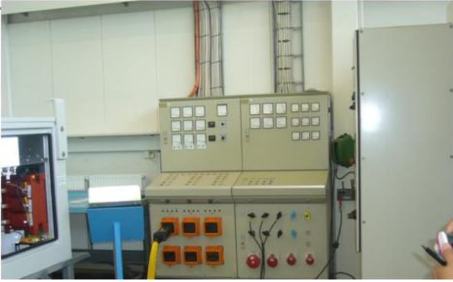
圖 36 工廠參觀-負載機控制台(變頻機測試用)
