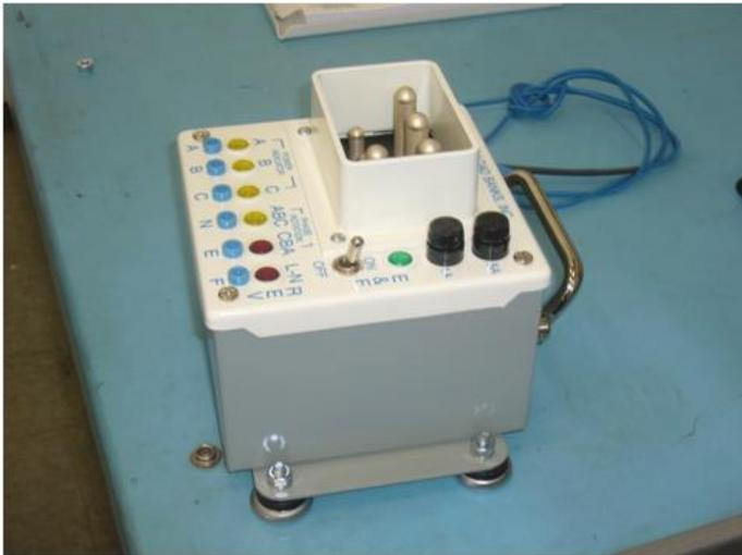
圖 19 以相序儀檢查變頻器接頭相序
