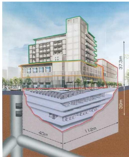
圖四 上二變電所地下層剖面圖示
