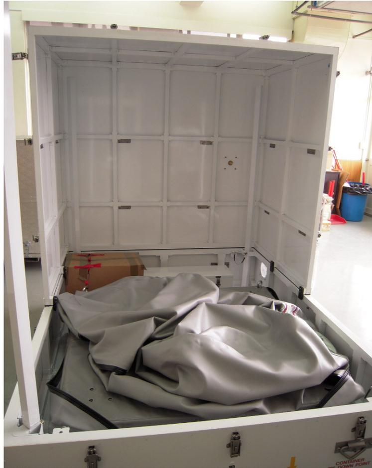
圖 6 歐洲設計量產型整體搬運機櫃外部鋁材蓋板及覆蓋塑膠防水布
