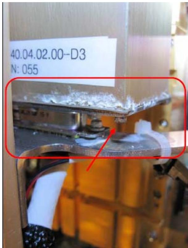
圖 37 底板與模組本身材質不同造成白鏽之化學變化
