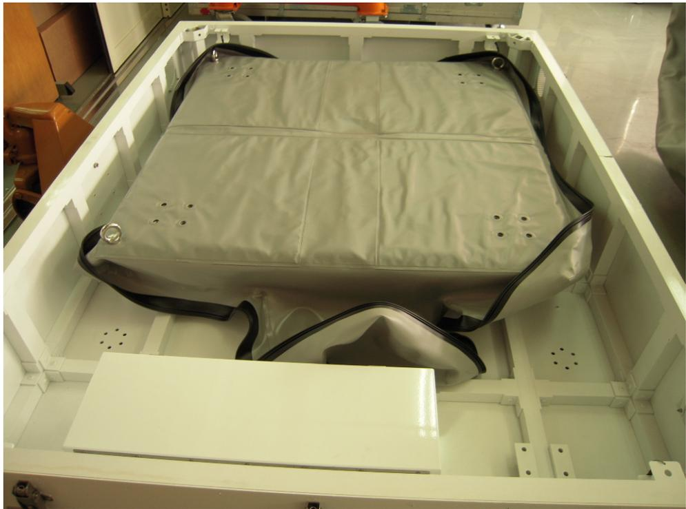
圖 7 歐洲設計量產型整體搬運機櫃避震底座
