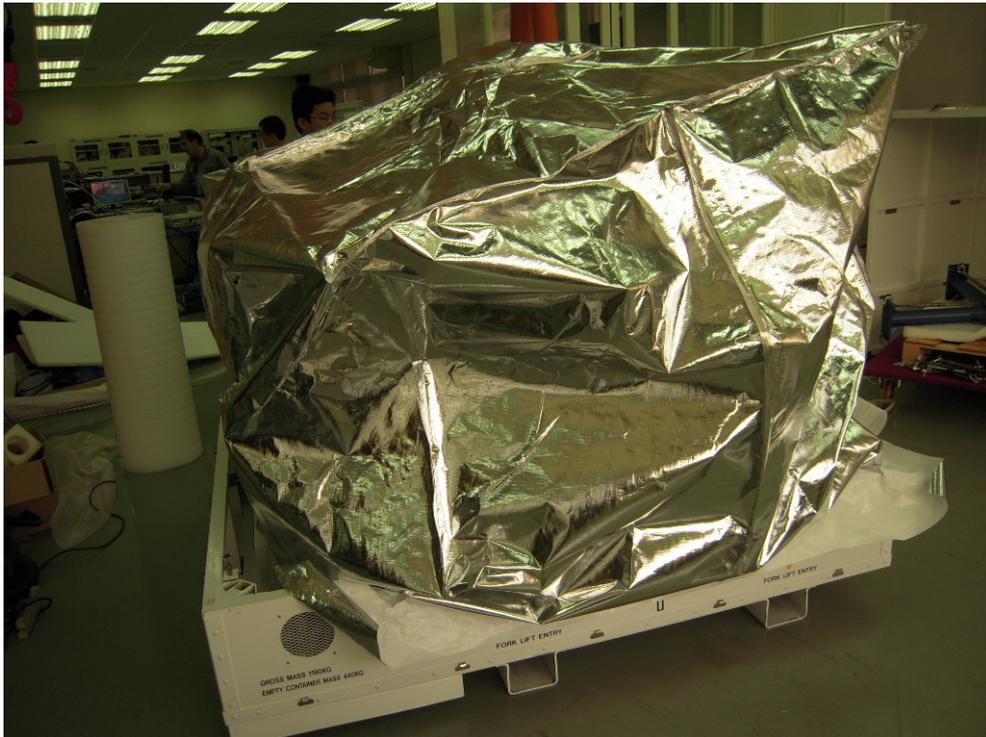
圖 10 除氣囊保護外本院再增加一層鋁膜真空包裝保護
