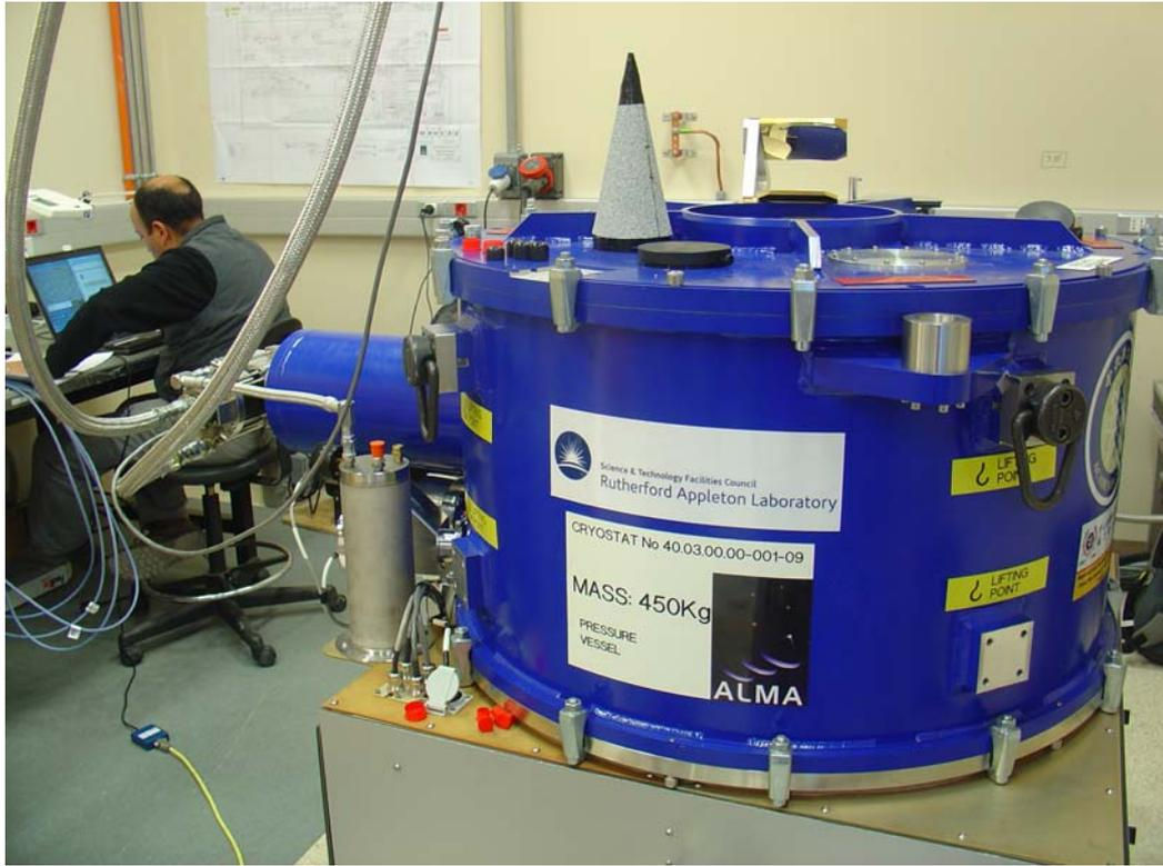
圖 34 使用吸波材料測試功率變化
