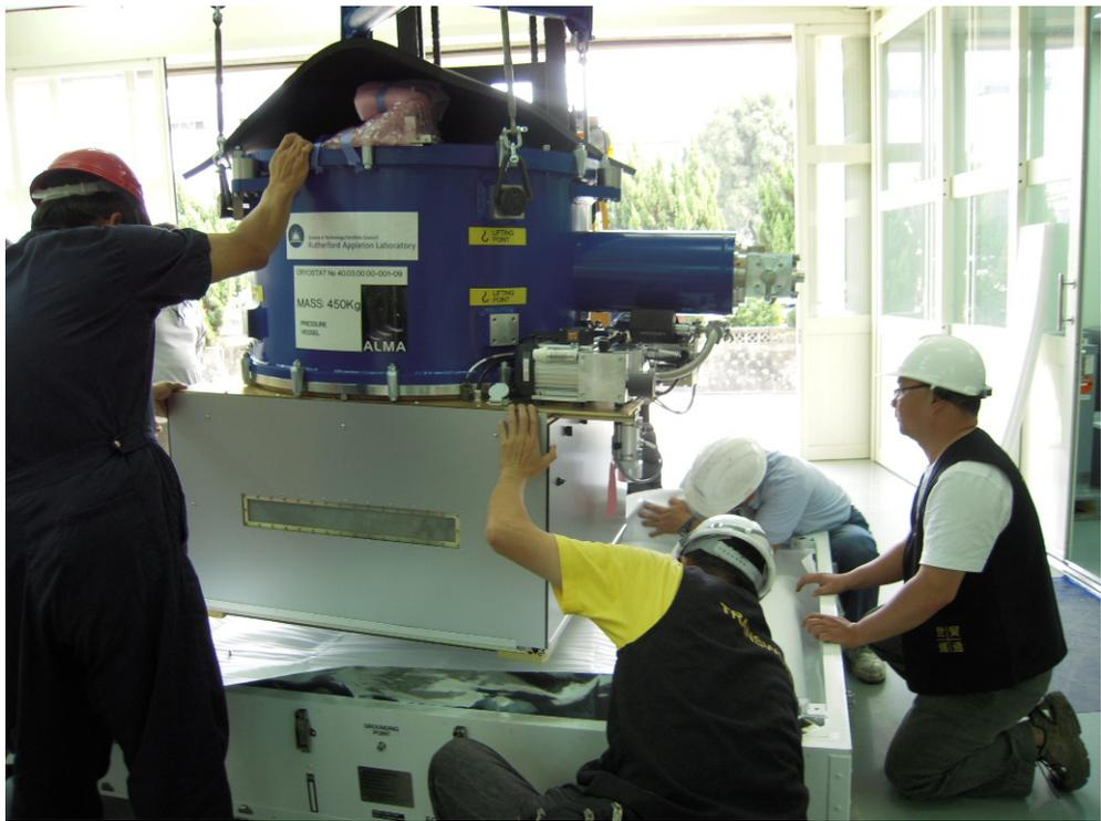
圖 8 第三具接收機在中科院安裝於量產型整機搬運機櫃
