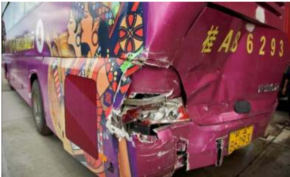
四車後車體撞毀，車輛雖可行駛但冷氣水箱故障導致車上已無冷氣
