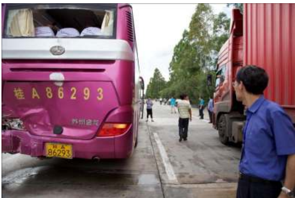
四車後車體撞毀，車輛雖可行駛但冷氣水箱故障導致車上已無冷氣
