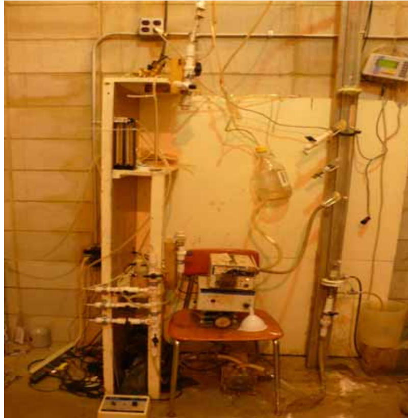
照片 1. 愛荷華州立大學土木環工系 Micro-Aeration for Sulfide Removal Bioreactor (1)
