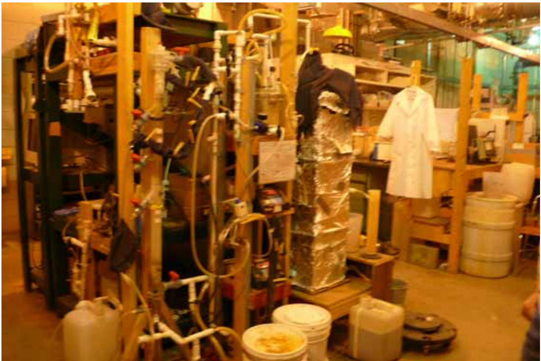
照片 2. 愛荷華州立大學土木環工系 Micro-Aeration for Sulfide Removal Bioreactor (2)
