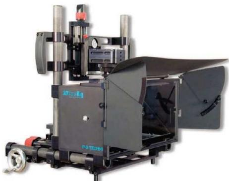
圖十二左 P+S Technik 標準型 3D 攝影儀
