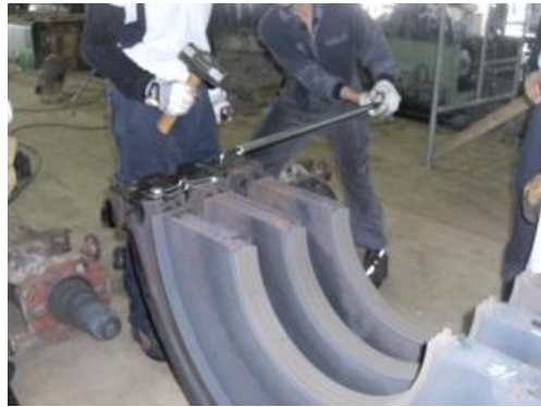
高中壓上半靜葉環固定螺絲拆卸
