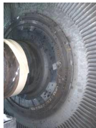
#11 加配重處(LH) LP-GE(No : 22)Disc(inner circle)
