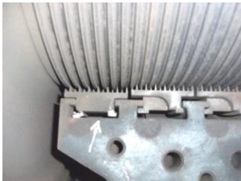
伍.1.2：拆卸靜葉環檢修汽封。
