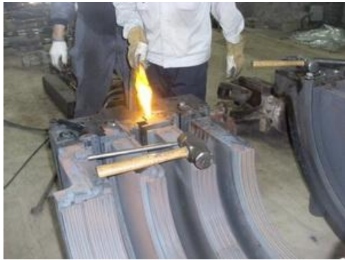
伍.1.3：拆卸保溫並修補損壞部分。
