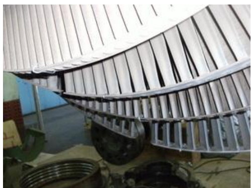
轉子吊出核測轉子下半間隙
