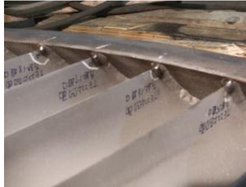
低壓靜葉環焊道缺陷焊補
