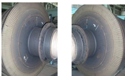
#4 加配重處(IP#9Disc) (RH) (LH)
