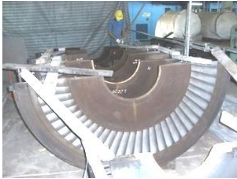
低壓靜葉環焊道缺陷焊補
