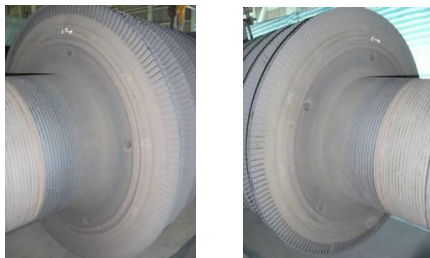
#4 加配重處(IP#9Disc) (RH) (LH)
