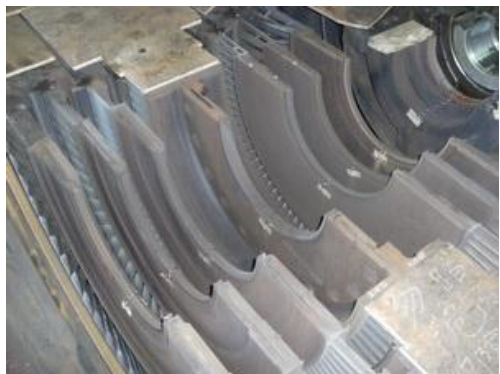
轉子吊出核測轉子下半間隙
