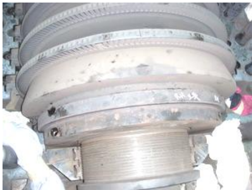
高中壓間隙核測
