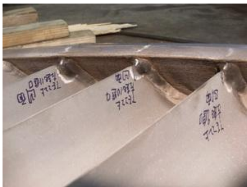
低壓靜葉環焊道缺陷焊補後 MT 檢測
