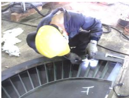
低壓靜葉環焊道缺陷焊補
