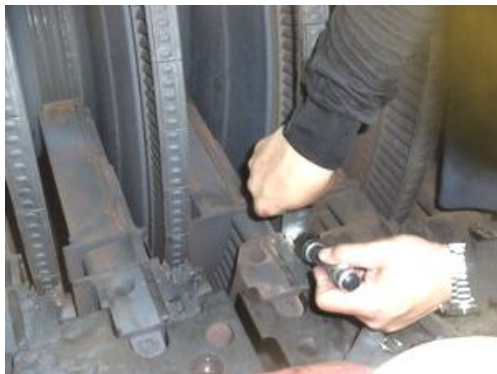
高中壓間隙核測
