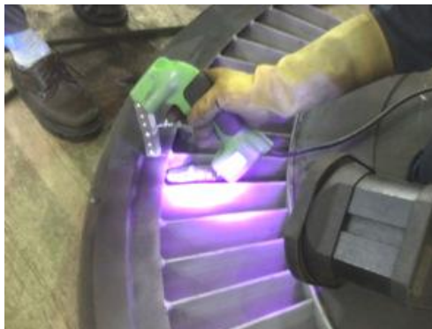
低壓靜葉環焊道缺陷焊補後 MT 檢測
