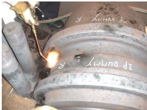
高中壓間隙核測
