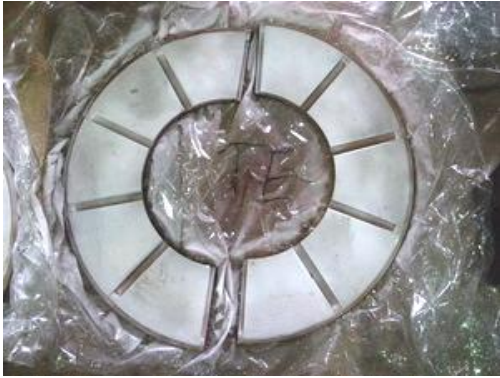
高壓內缸導軌 MT 檢測
