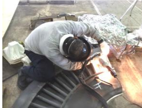
低壓靜葉環焊道缺陷焊補
