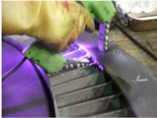
伍.1.6：各組件 MT&PT 檢測。 轉子 MT 檢測
