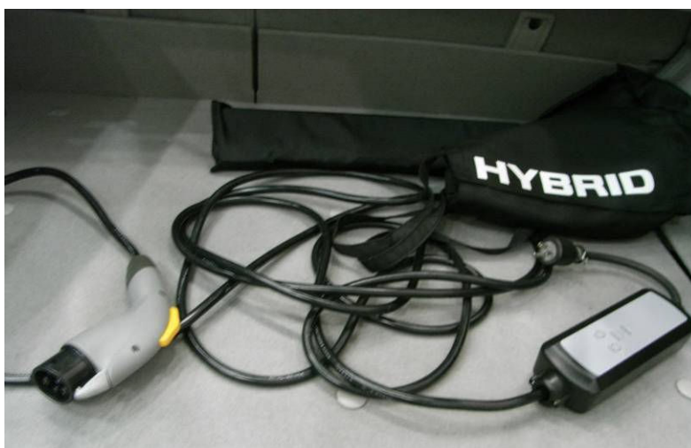
圖二十九： 油電混合動力車設計之市電充電連接器
