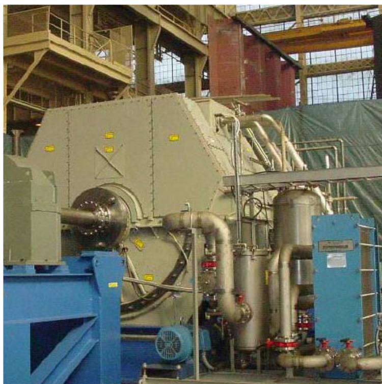
圖十八：使用高溫超導 36.5MW 電動機
