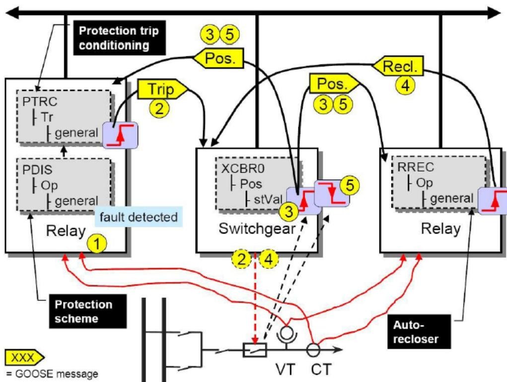
當系統發生故障由保護電驛偵測到故障，於圖中左半部所示，其動作順序分別為，PDIS(測距保護電驛)作動並發出 Tr(跳脫指令)，XCBRO(斷路器)接獲跳脫指令，其狀態值 stVal(TRUE/FALSE)開始轉態，同時復閉電驛 RREC 作動，發出指令準備復閉，斷路器 XCBRO 在接獲指令後，斷路器開始轉態；其動作順序如圖中數字符號由數字 1 分別動作至數字 5，圖中的黃字箭號代表 GOOSE 訊息。
