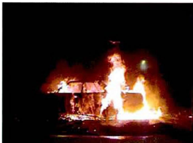
圖 25 壓縮氫氣容器搭載於車輛的火災試驗
