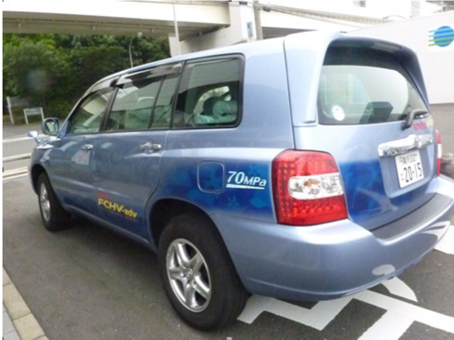
圖 18 70MPa 之氫能燃料電池車
