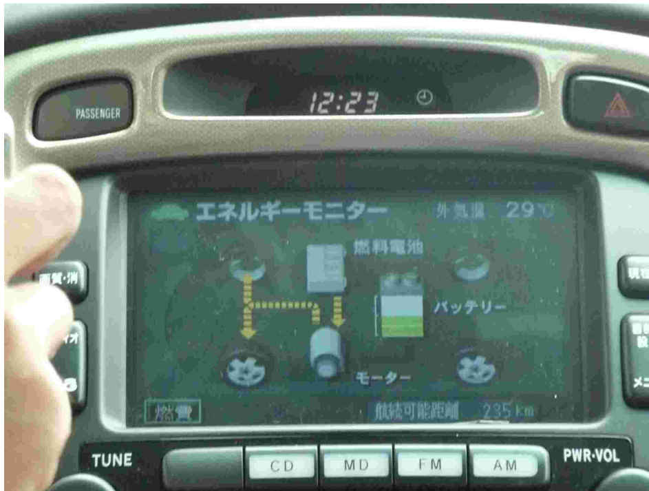
圖 19 操作過程即時顯示動力來源與電能回收狀態
