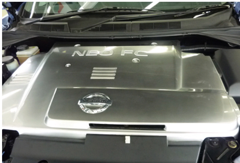
圖 16 車用燃料電池安裝於引擎室之狀態
