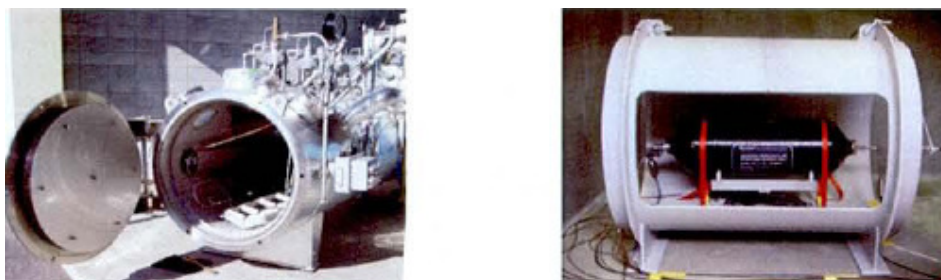
圖 26 氫氣滲透設備(左)、氫氣充填循環試驗用槽(右)
