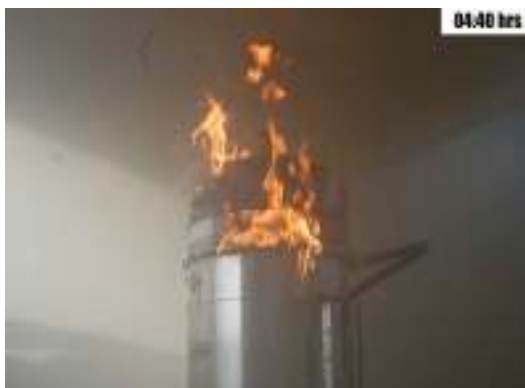
照片 35：經過 4 小時 40 分鐘後吸塵器上蓋整個燃燒起火。
