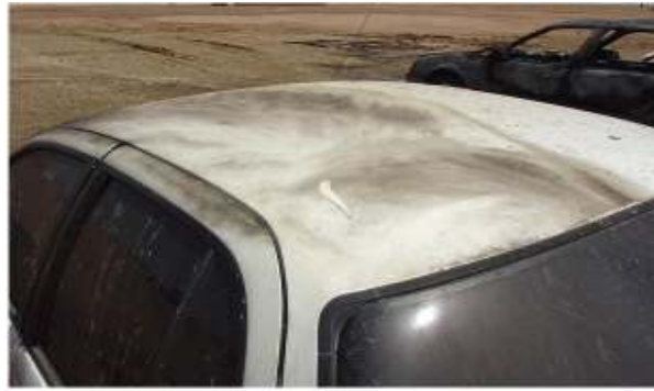
照片 19：車頂無金屬受燒後之氧化或脫漆等狀態，僅有輕微之煙燻現象。
