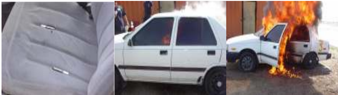
照片 20~22：點燃香煙置於駕駛座沙發上，同時關閉車門及車窗，不久車內有火光及白煙冒出，打開車門後即激烈燃燒。
