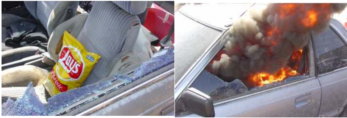
照片 23、24：點燃洋芋片在空氣量及可燃物足夠狀態下，馬上引發劇烈燃燒並產生大量灰黑煙。
