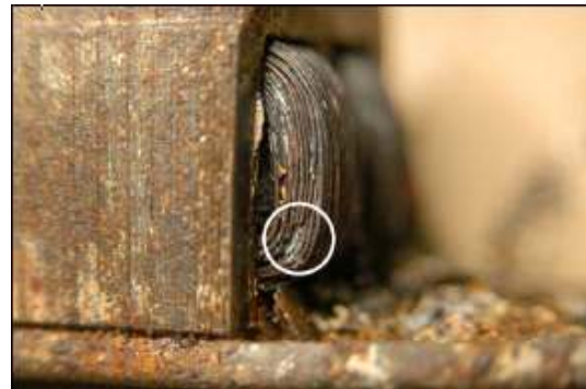
照片 27：線圈有局部熔化燒損情形。
