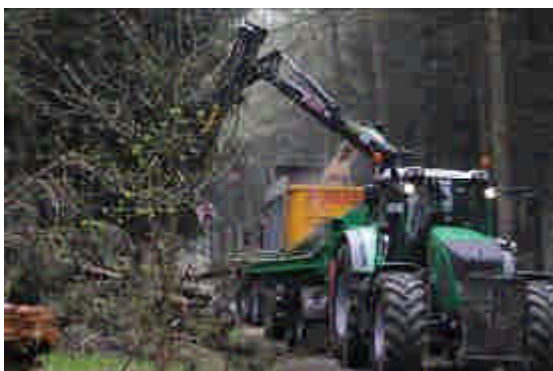
圖 6. 在化石能源日益不足下，德國政府推廣民間使用可直接燃燒木片的暖氣系統，並發展出能就地將中小徑木及枝條打成木片的大型機具以減少林木運送的成本。
