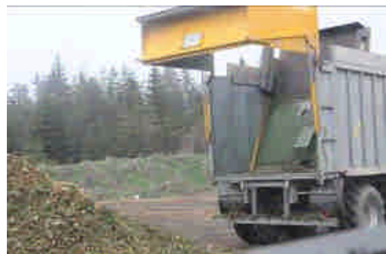
圖 6. 在化石能源日益不足下，德國政府推廣民間使用可直接燃燒木片的暖氣系統，並發展出能就地將中小徑木及枝條打成木片的大型機具以減少林木運送的成本。
