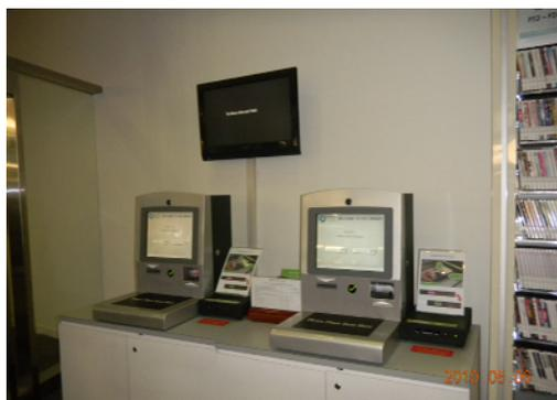
圖 17：HF RFID 自助借光碟機及解鎖機器
