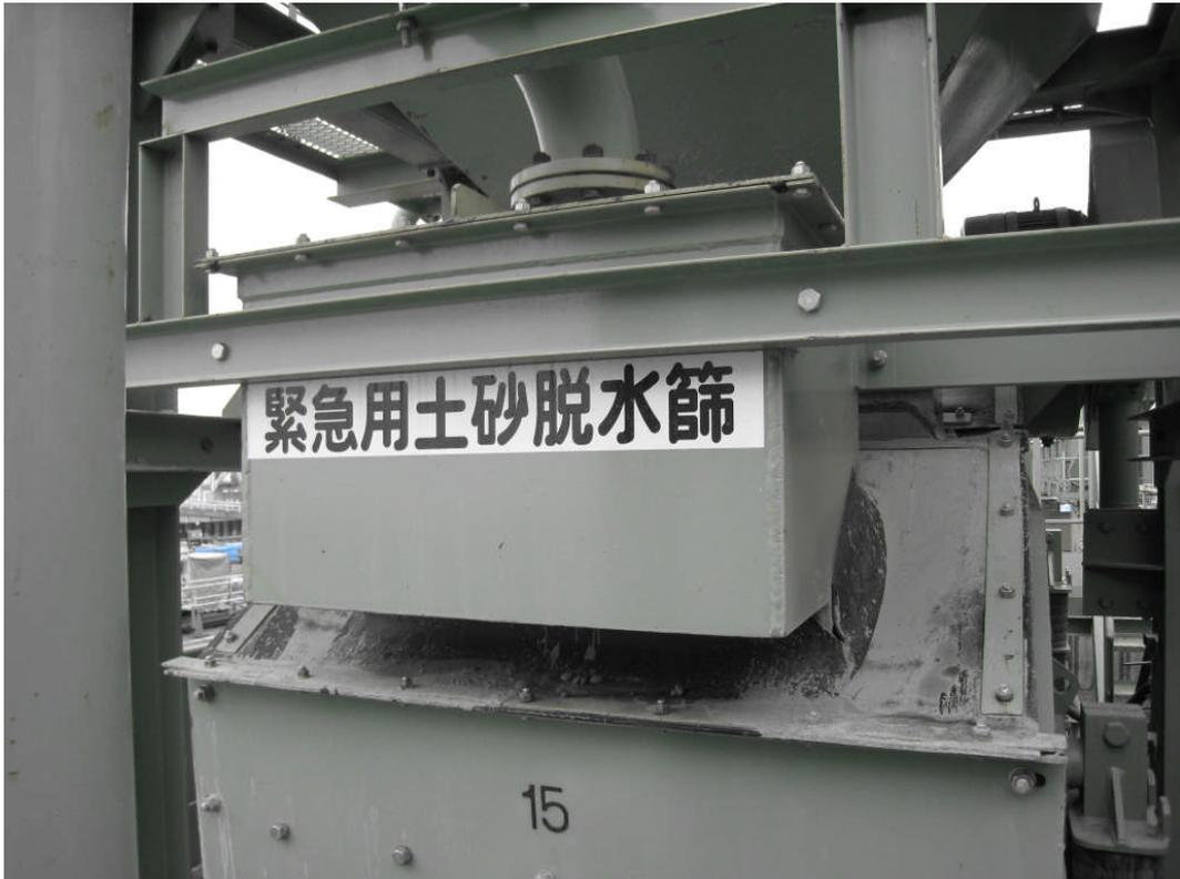
照片 2.2.6.2-8 泥水處理設施(泥水中土沙<#200 過多時使用)
