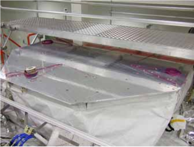
圖五十三：天頂導熱板安裝完成
