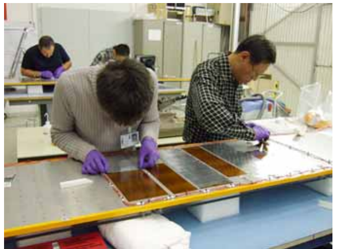
圖六：軌跡導熱板鋁箔黏貼工作
