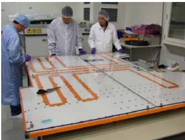
圖二十七：以簽字筆於四片透明保護板上標示鑽孔位置
