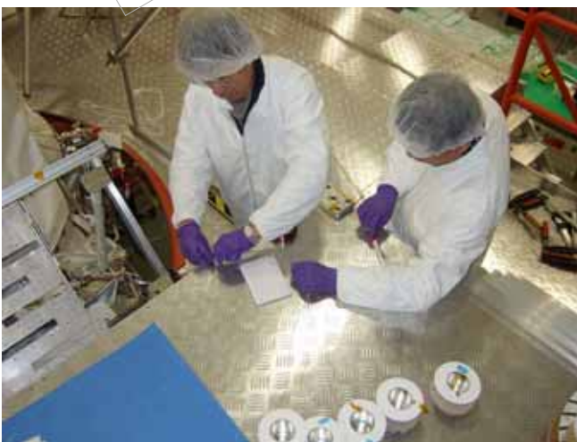
圖十一：溫度訊號纜線製作
