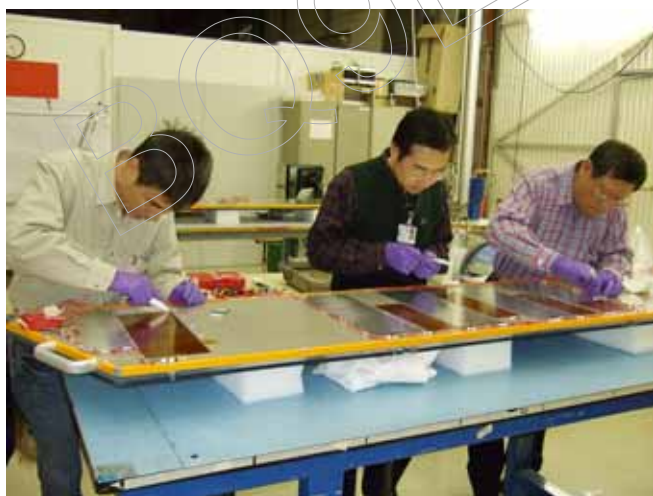
圖七：軌跡導熱板鋁箔黏貼工作
