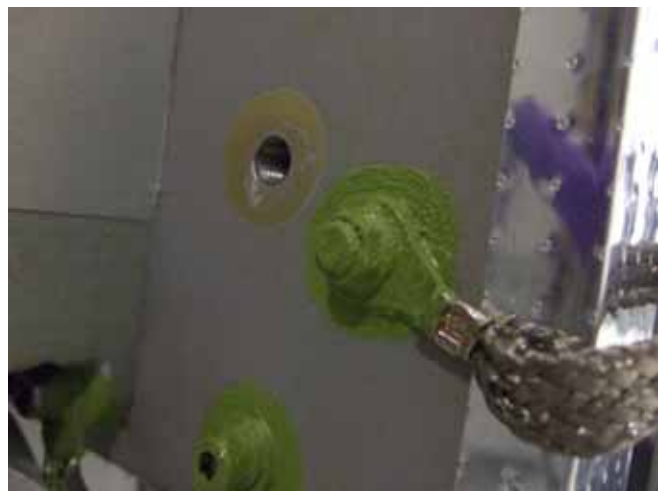
圖三十八：電子系統接地線螺絲需上綠色導電膠
