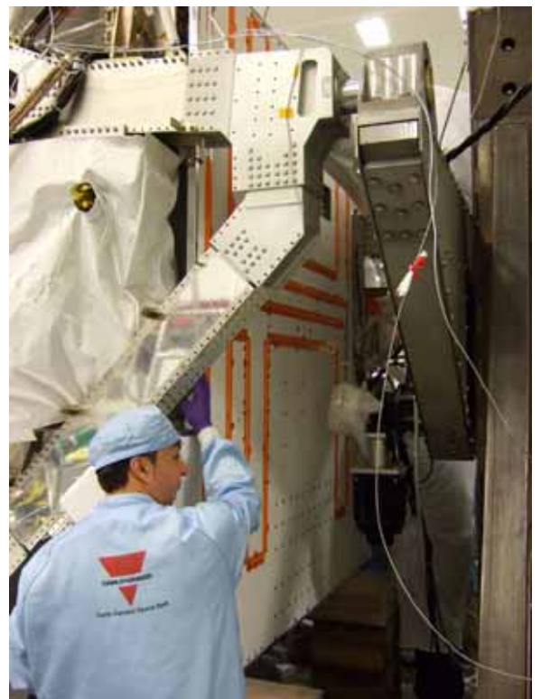
圖三十四：導熱板下方以實心木塊一層一層往上墊高，進行對位
