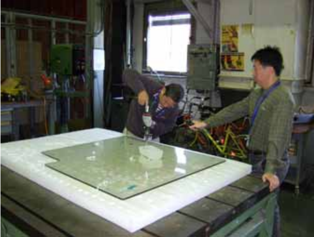
圖三十一：一邊鑽孔一邊使用對著刀具吹風，可幫助刀具導熱也可將沾黏在刀具上的壓克力屑移除，讓刀具更有效率
