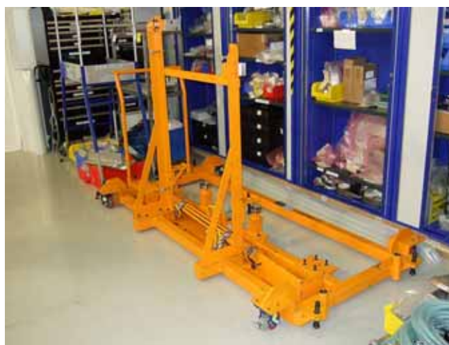
圖八：機匣支撐架推車組裝完成
