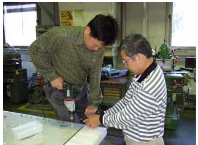
圖二十八：依照標示進行鑽孔，四片透明保護面板共二百三十餘個孔位
