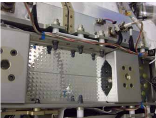
圖三十七：走線宜再加一條束線帶固定
