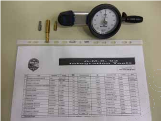
圖三十五：備齊量測 running torque 所需工具
