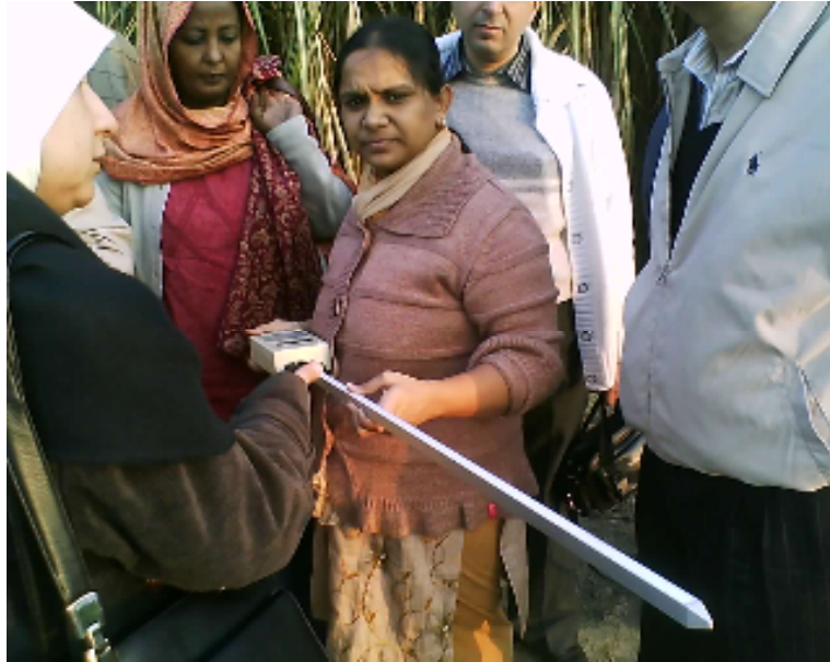
圖 13、於農地中測量太陽輻射值。
