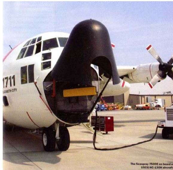
圖十一：力士型偵搜機安裝海浪偵搜雷達
