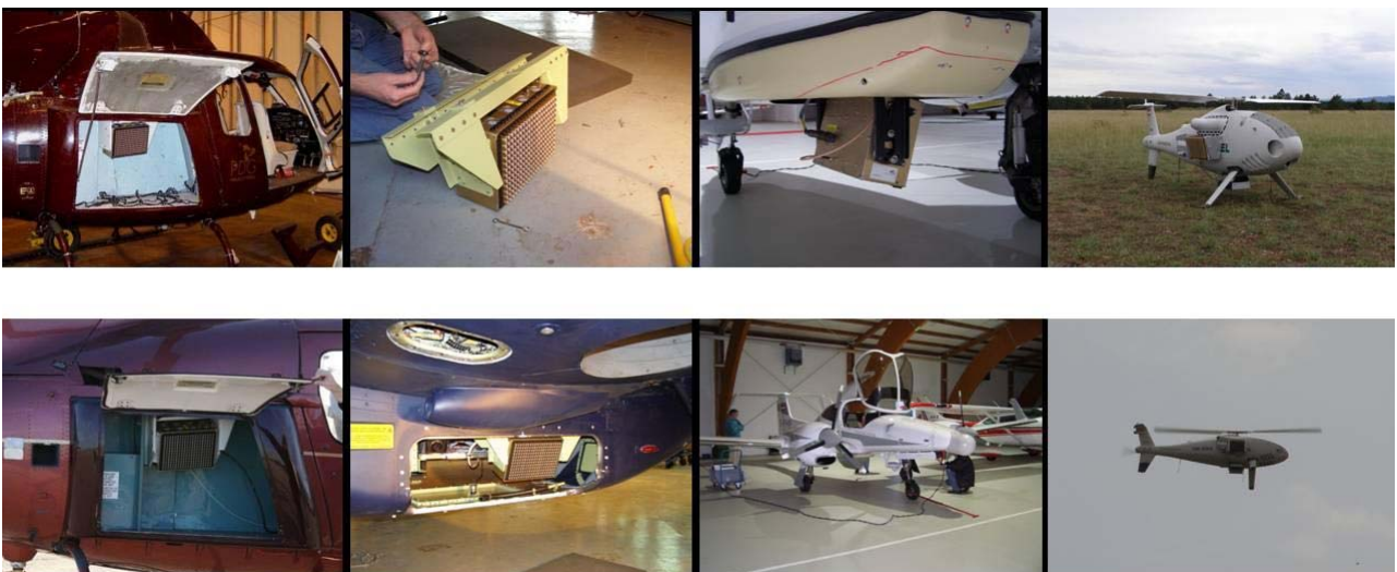
圖五：皮克合成孔徑雷達於不同載具安裝實例
