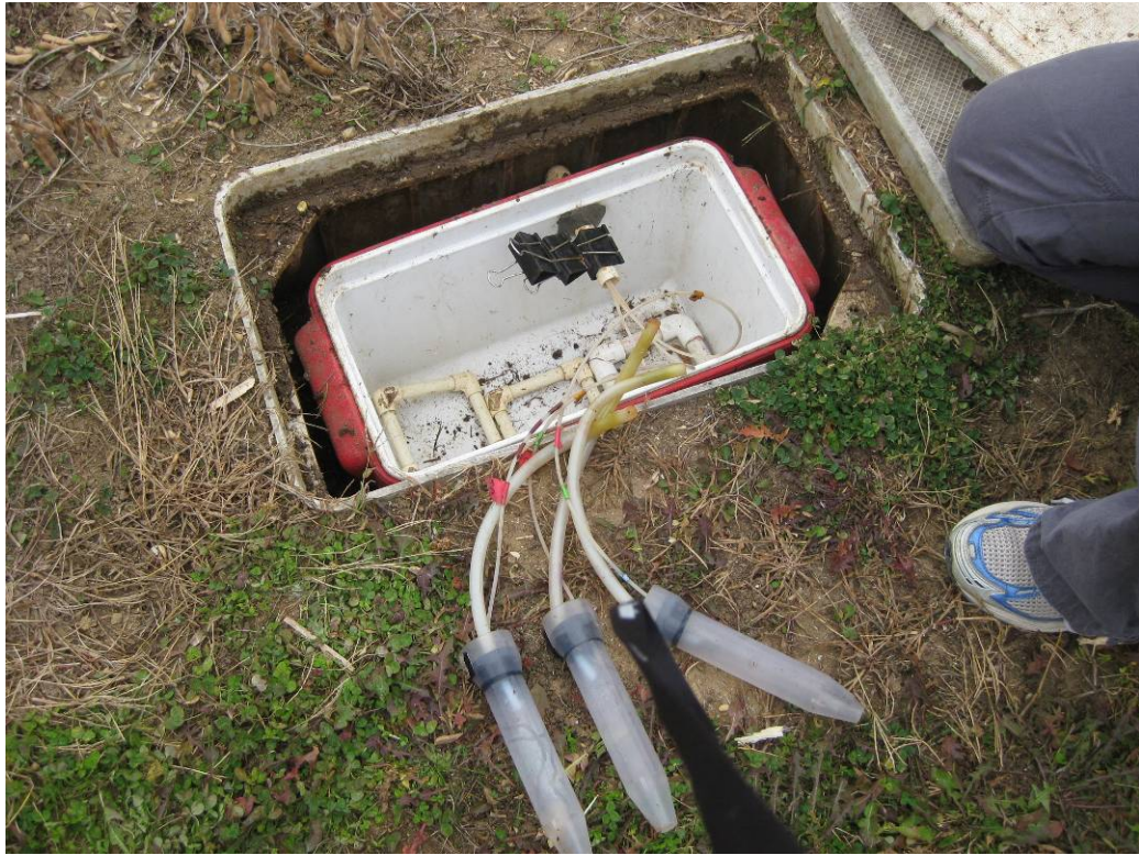
圖 3. KBS LTER 滲漏計滲漏水收集
