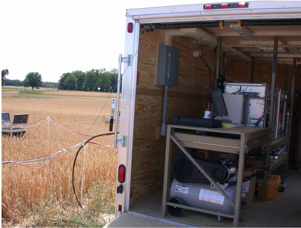
圖 7. KBS LTER-溫度氣體排放自動測量系統
