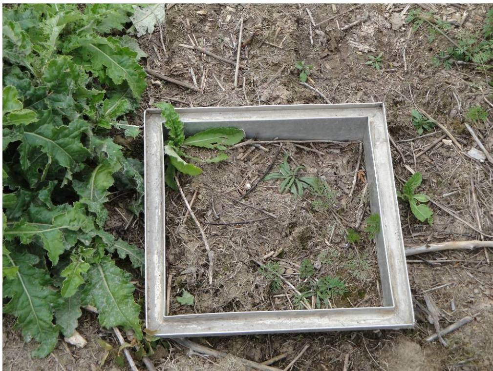
圖 4. KBS LTER 土壤氣體收集器底部
