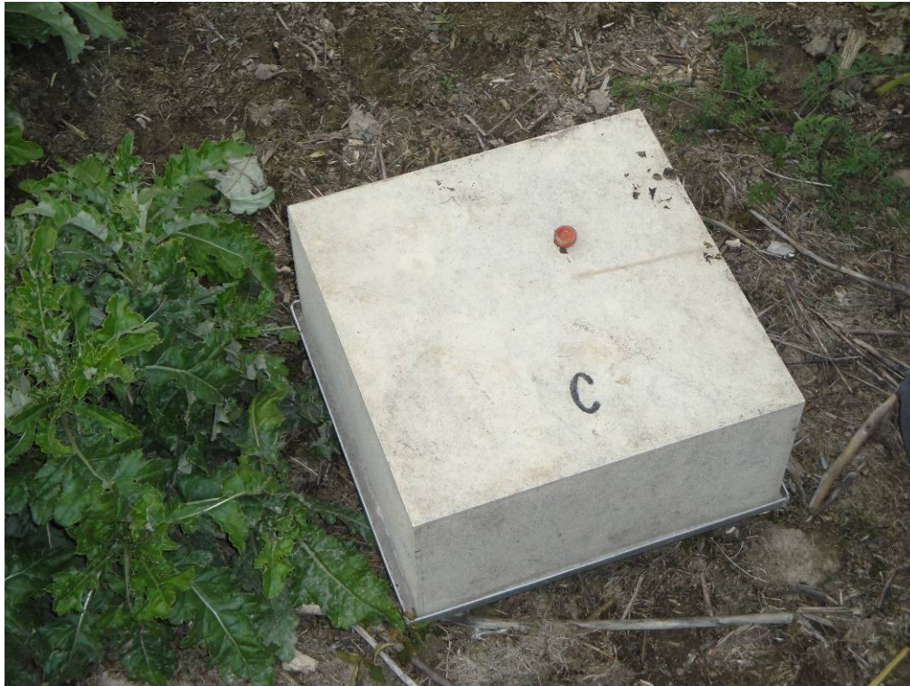
圖 5. KBS LTER 土壤氣體收集器外觀
