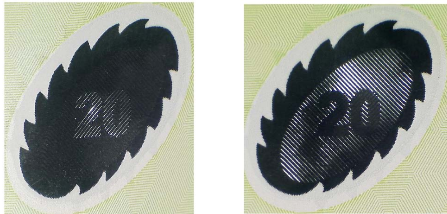
圖 2-1 紐幣上之瞬間空壓圖紋，將其略微傾斜可辨識出空壓效果
