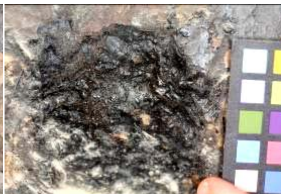
圖三十五 清潔示範區：6) Carbopol + Iso Propanol + Ethomeen ， 7) Carbopol + NH 3 + Iso Propanol 溶解煙燻，3) Belfor SRF 2NA 可將他移除。
