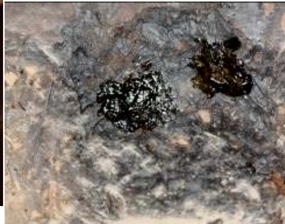
圖三十一 清潔示範區：使用 6) Carbopol + Iso Propanol + Ethomeen ， 7) Carbopol + NH 3 + Iso Propanol:細部照片。
