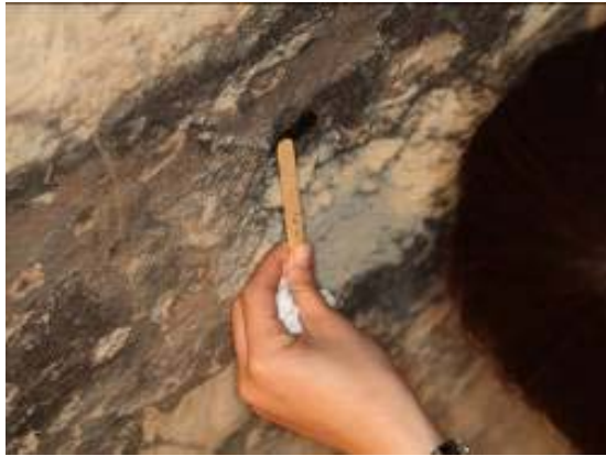
圖三十 清潔示範區：使用 6) Carbopol + Iso Propanol + Ethomeen ， 7) Carbopol + NH 3 + Iso Propanol 。
