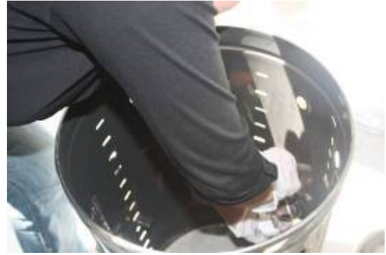
圖三 刮取烤爐上的煙燻殘留，以利於在顯微鏡下觀察並做清潔測試。
