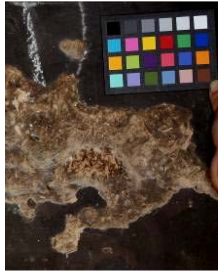
圖二十八 清潔示範區：使用 3) Belfor SRF 2NA。清潔後。
