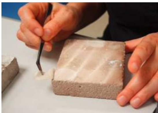
圖九 3) Belfor SRF 2NA 乾燥後，形成薄膜，便可將其撕除。
