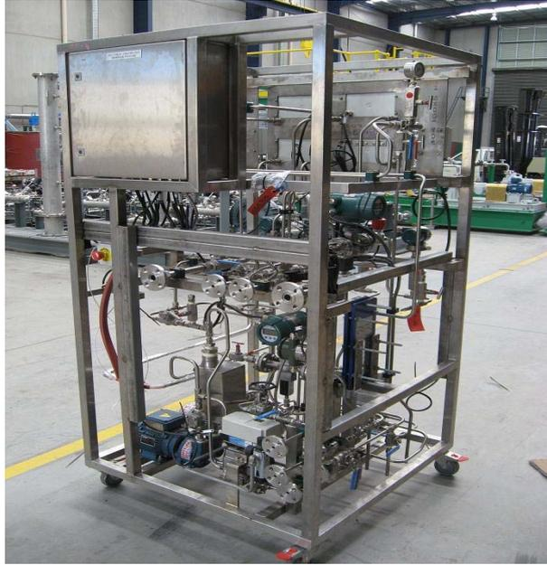
圖 14 CO2CRC H3 捕捉計畫的薄膜設施 (Membrane Skid)
