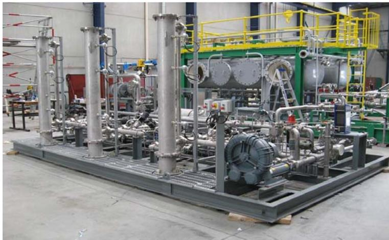
圖 15 CO2CRC H3 捕捉計畫的吸附設施 (Adsorbent Skid)
