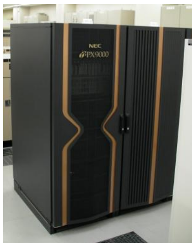
圖 7、RDP 系統的中央處理裝置
