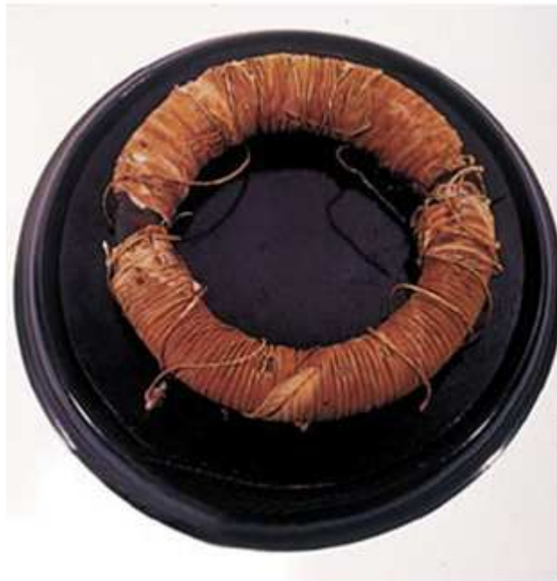
圖 2.3 法拉第當時實驗所使用的線圈
