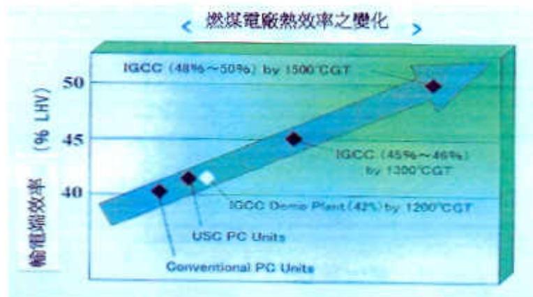
圖 19. 燃煤電廠熱效率之變化
